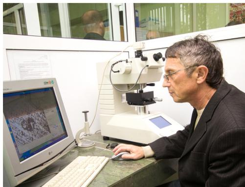
*С.н.с. Лончаков С.З. измеряет микротвердость материала*
