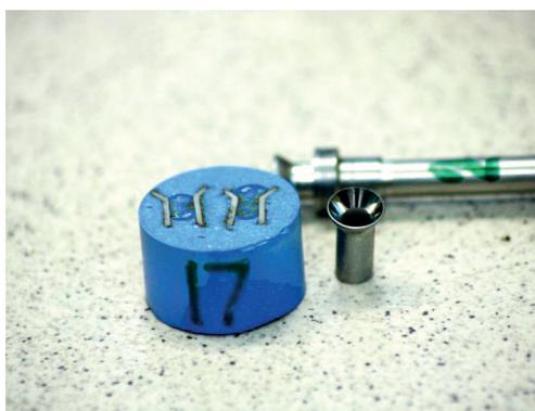
*От детали – к исследуемому образцу, прошедшему пробоподготовку*
