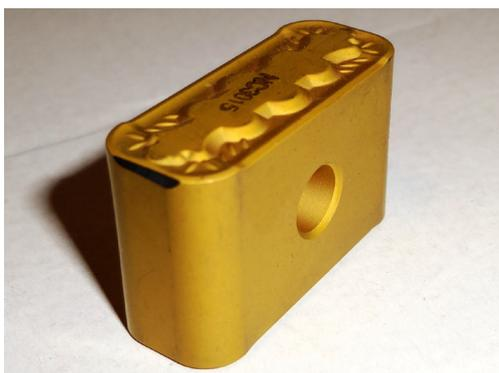
*Колёсотокарная режущая пластина, подвергнутая термомеханическому упрочнению*
