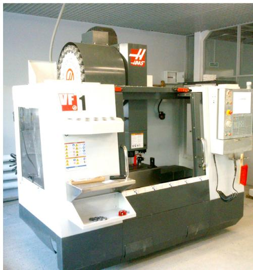
*Вертикально-фрезерный обрабатывающий центр с ЧПУ VF-1*
