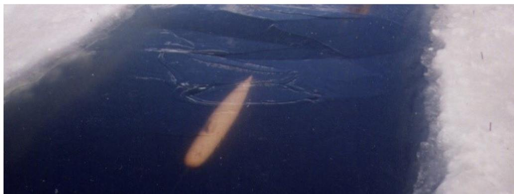
*Разрушения льда моделью подводного судна*
