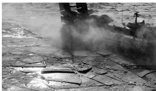
*Разрушение льда ДКВП «Скат»
