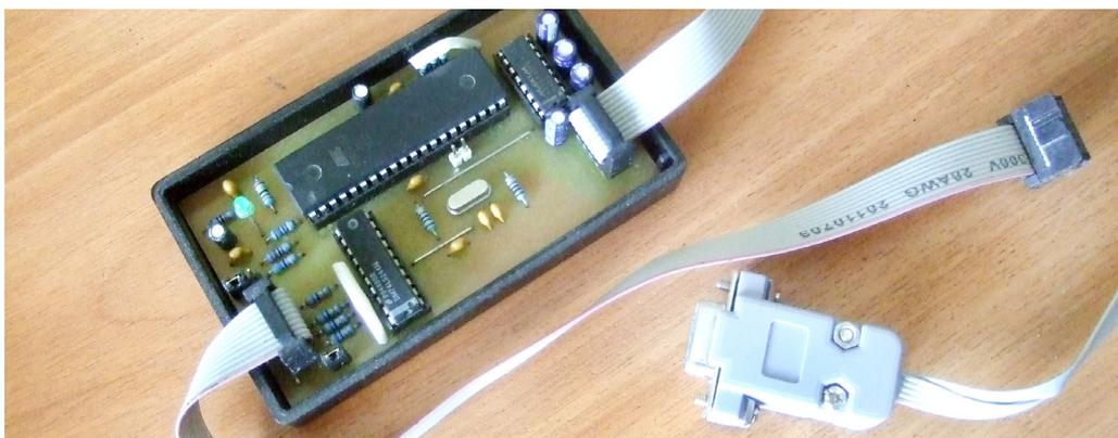
*Программатор-отладчик для микроконтроллеров, изготовленный студентами СКБ ЭТФ*
