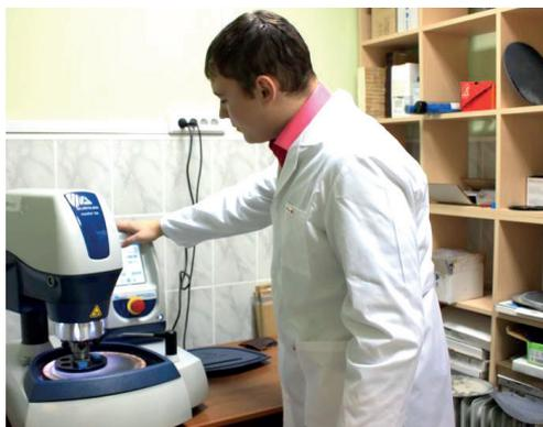
*Процесс подготовки проб на шлифовально-полировальном станке*
