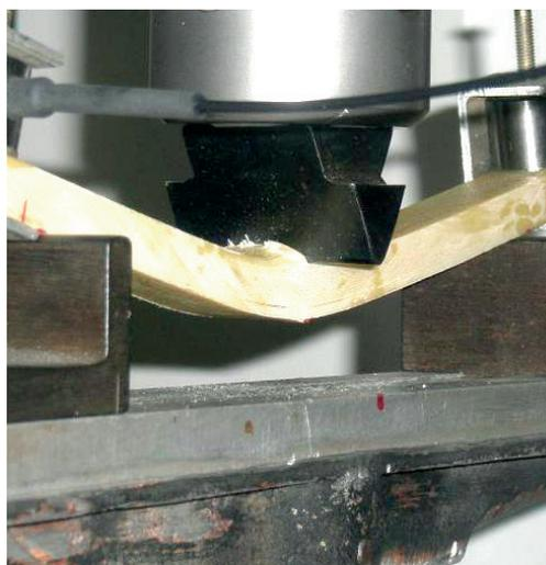
*Испытание стекловолоконного материала с одновременной регистрацией акустической эмиссии*
