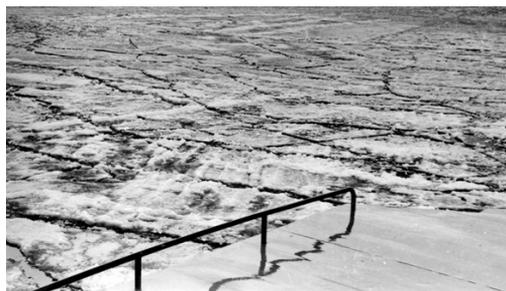
*Характер разрушения ледяного покрова ДКВП «Мурена»*
