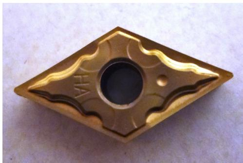
*Пример режущей пластины с разработанным высокопрочным износостойким покрытием*
