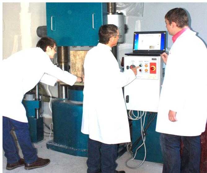
*Сотрудники лаборатории осуществляют запуск испытательного комплекса из прессов ИП-100М-авто и ИП-2500М-авто*
