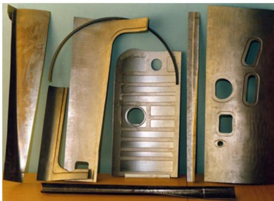
*Формообразование заготовки из сплава ВТ20 в процессе электроконтактного нагрева и охлаждения ее в штампе*
