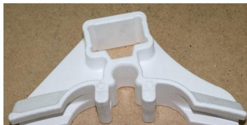
*Трехмерная пенополистироловая модель отливки*
