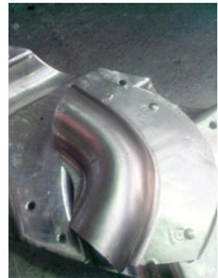
*Совершенствование технологии и оснастки для изготовления деталей из листового материала методом формообразования эластичными средами на прессе при высоких давлениях*
