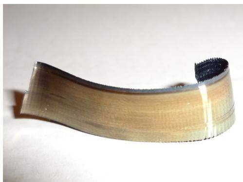
*Пример стружки, образованной при сложных условиях обработки*
