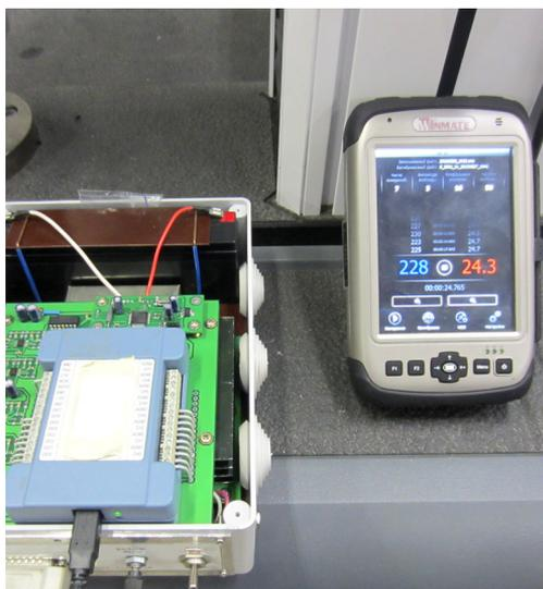
*Разработанный ООО «ЭСКО» прибор для измерения напряженного состояния металлов*
