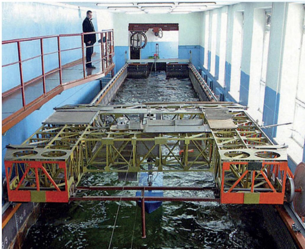
*Испытание модели судна в опытном бассейне КНАГТУ*
