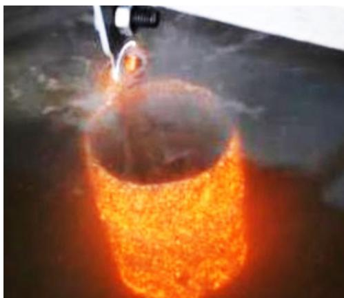
*Процесс оксидирования цилиндрического изделия*
