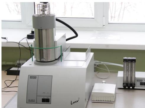
*Синхронный термоанализатор STA 409 PC*
