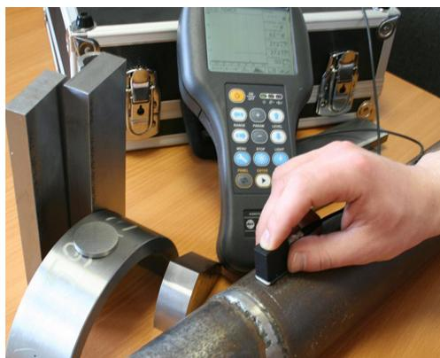
*УЗК контроль образцов сварных швов*
