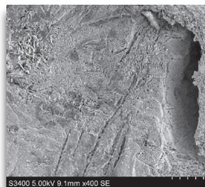
*Трещина в металле*
