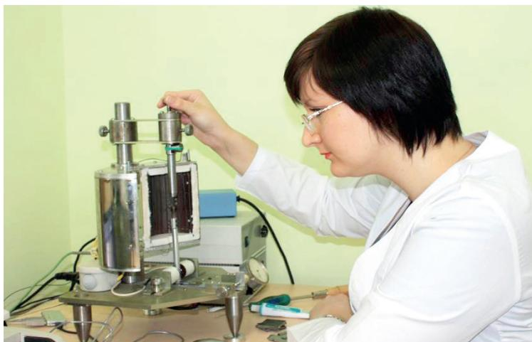
*Циклические испытания на установке для исследования усталости материалов*
