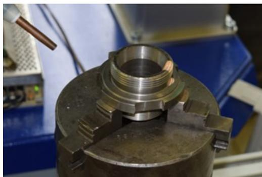
*Изделие закреплено в патрон для автоматизированной лазерной обработки*
