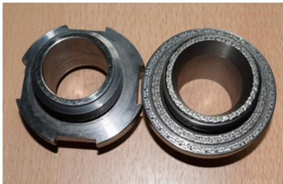
*Клапан до и после поверхностной лазерной обработки*
