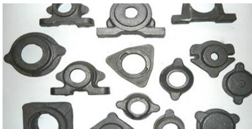
*Отливки из сплава 45Л*
