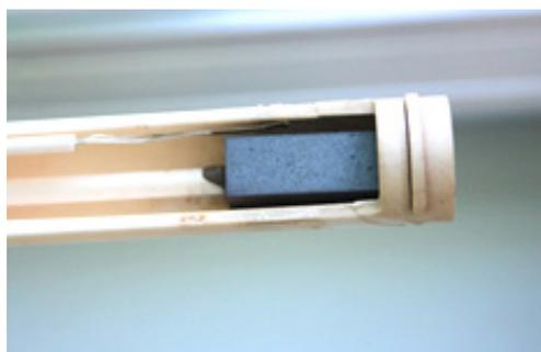
*Образец, установленный в дилатометре*
