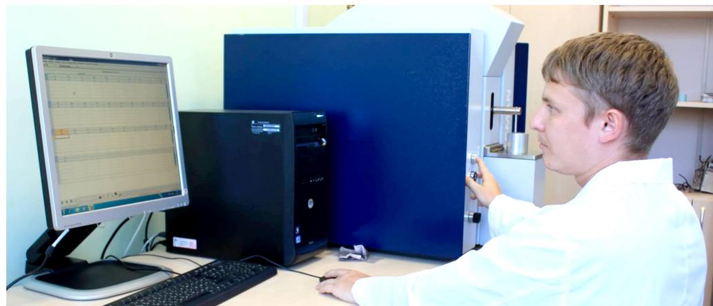
*Работа на оптико-эмиссионном спектроанализаторе Q4 TASMAN 170 Bruker*
