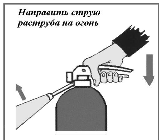
Рисунок А.3– Приведение углекислотного огнетушителя в действие
