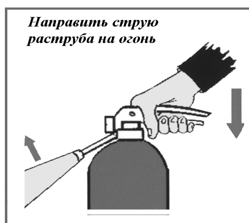
Рисунок А.3– Приведение углекислотного огнетушителя в действие
