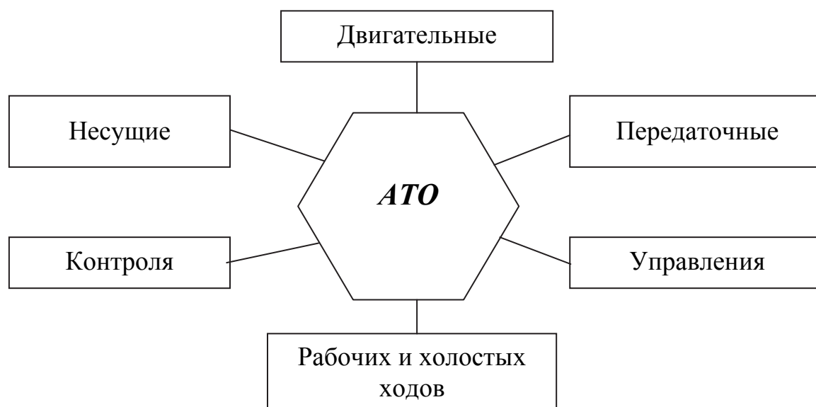
Рис. 3.1. Основные элементы и механизмы автоматизированного технологического оборудования
