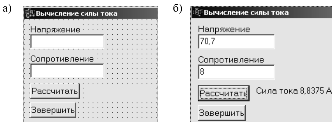
Рис. 3.1. Форма разрабатываемого приложения в режиме проектирования (а) и в режиме выполнения (б)
