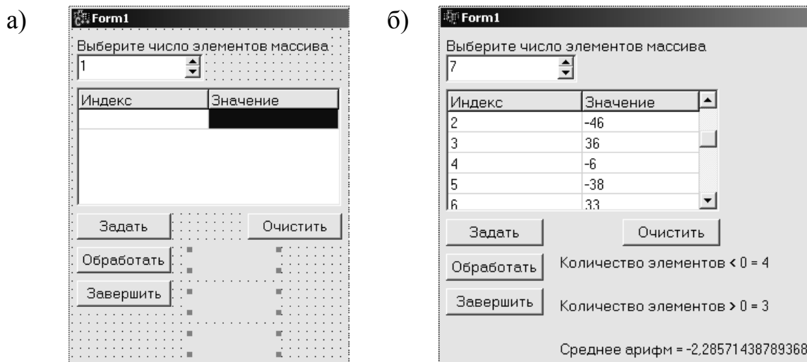
Рис. 3.4. Форма разрабатываемого приложения в режиме проектирования (а) и в режиме выполнения (б)
