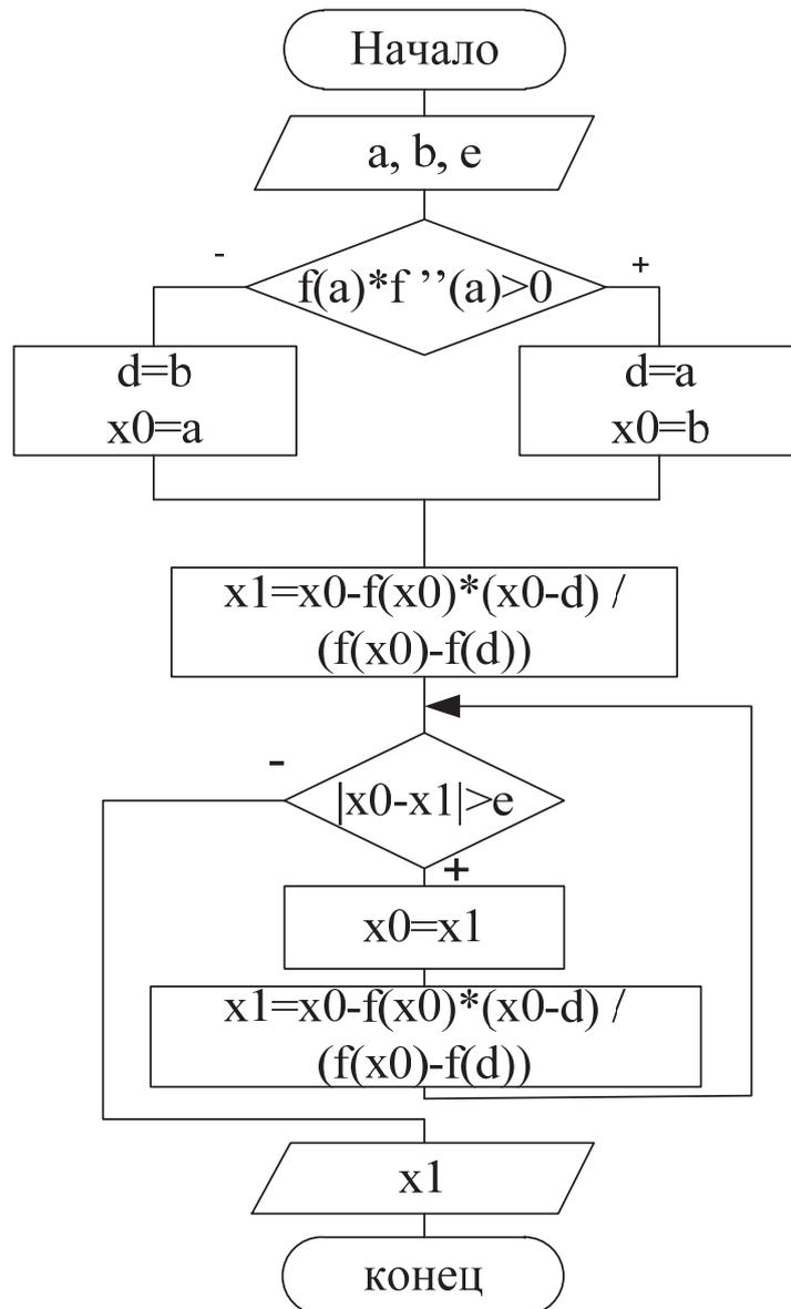
Рис. 3.20. Блок схема алгоритма метода хорд
