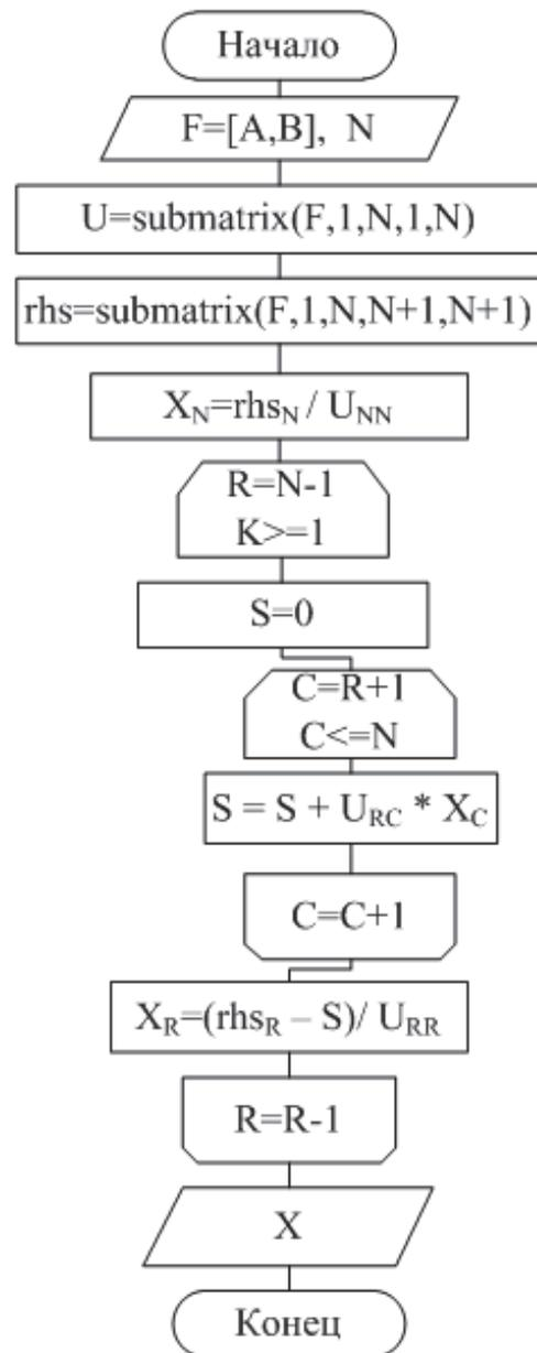
Рис. 4.4. Блок-схемы: а – алгоритма, реализующего прямой ход метода Гаусса без выбора ведущего элемента;
