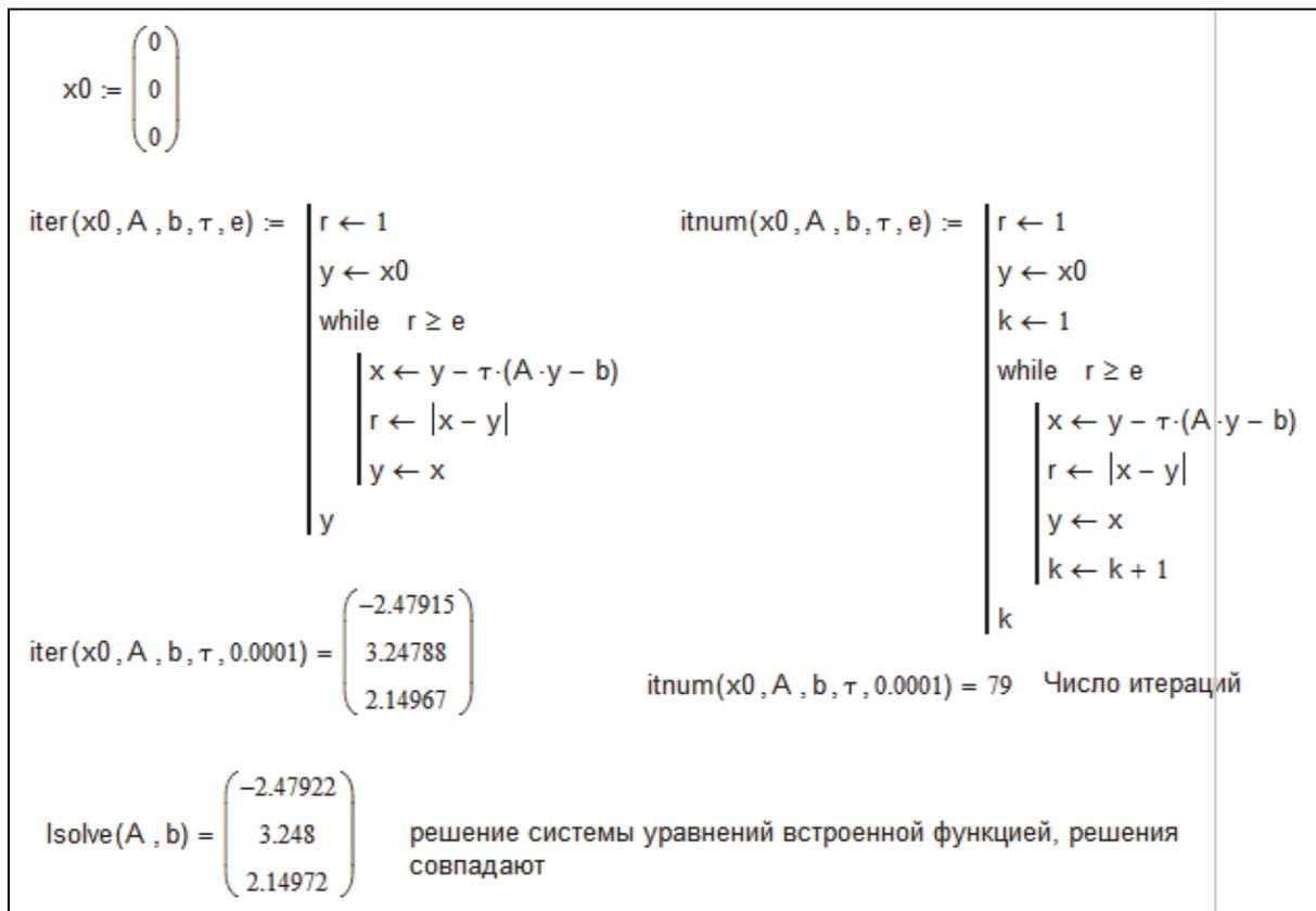
Рис. 4.14. Решение системы линейных алгебраических уравнений методом простых итераций
