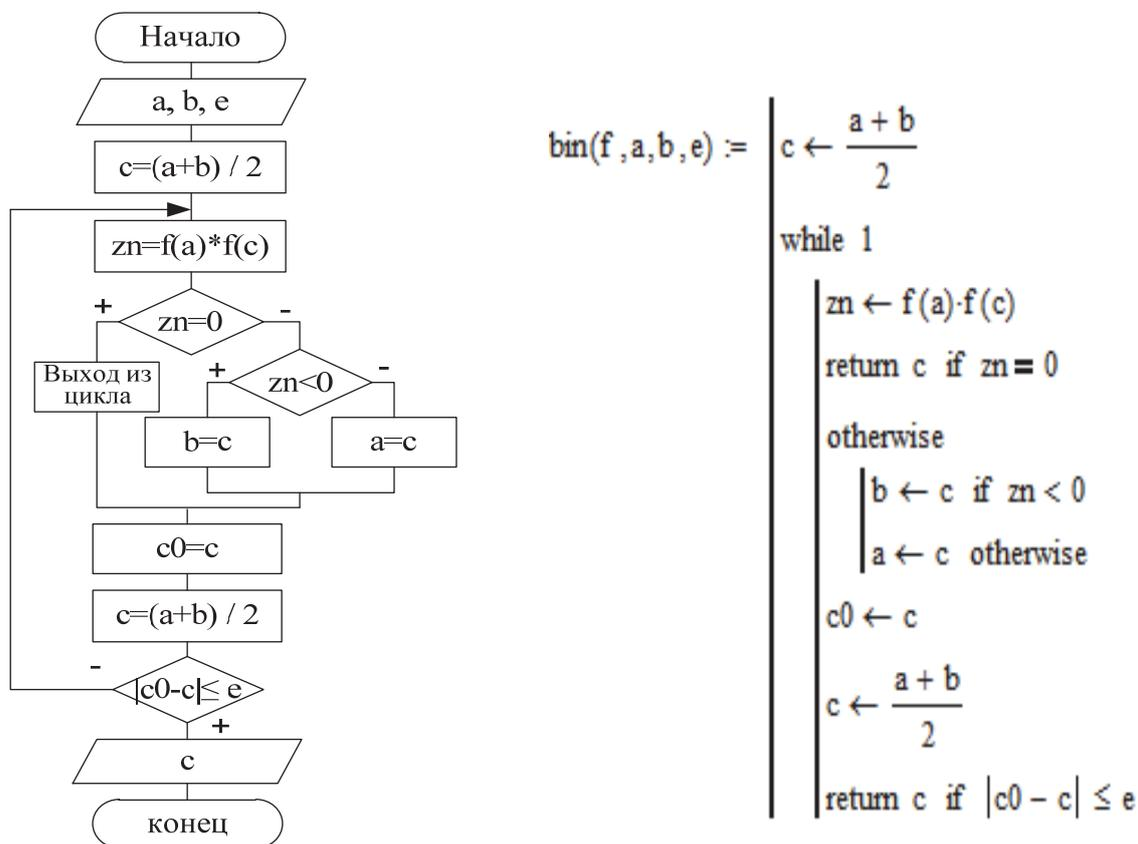
Рис. 3.4. Блок-схема алгоритма решения нелинейного уравнения (3.1) методом бисекции и реализация алгоритма в MathCad
