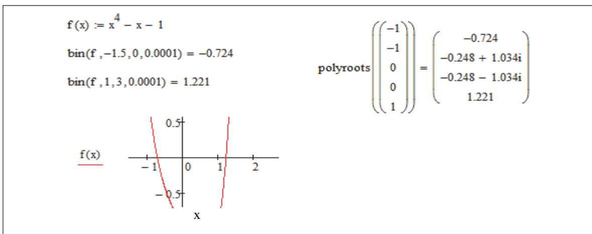
Рис. 3.5. Пример решения нелинейного уравнения методом бисекции в MathCad
