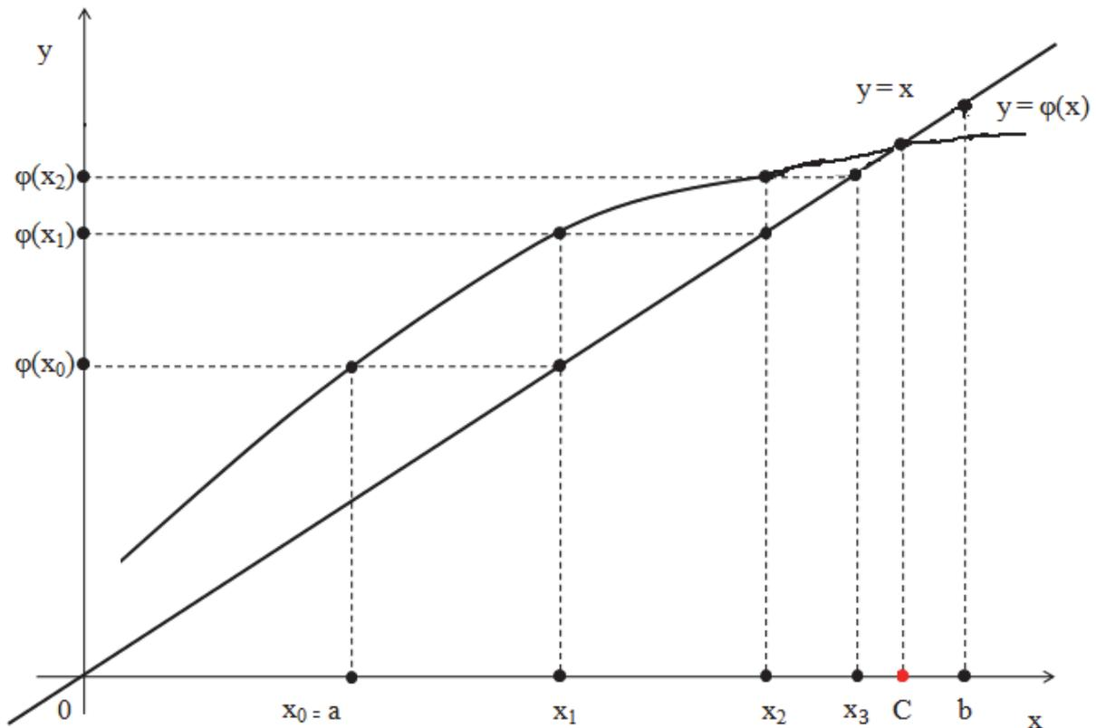
Рис. 3.6. Решение нелинейного уравнения методом простых итераций
