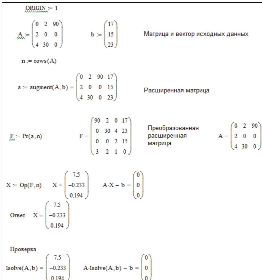
Рис. 4.12. Решение системы уравнений методом Гаусса с полным выбором ведущего элемента с использованием ранее написанных функций пользователя
