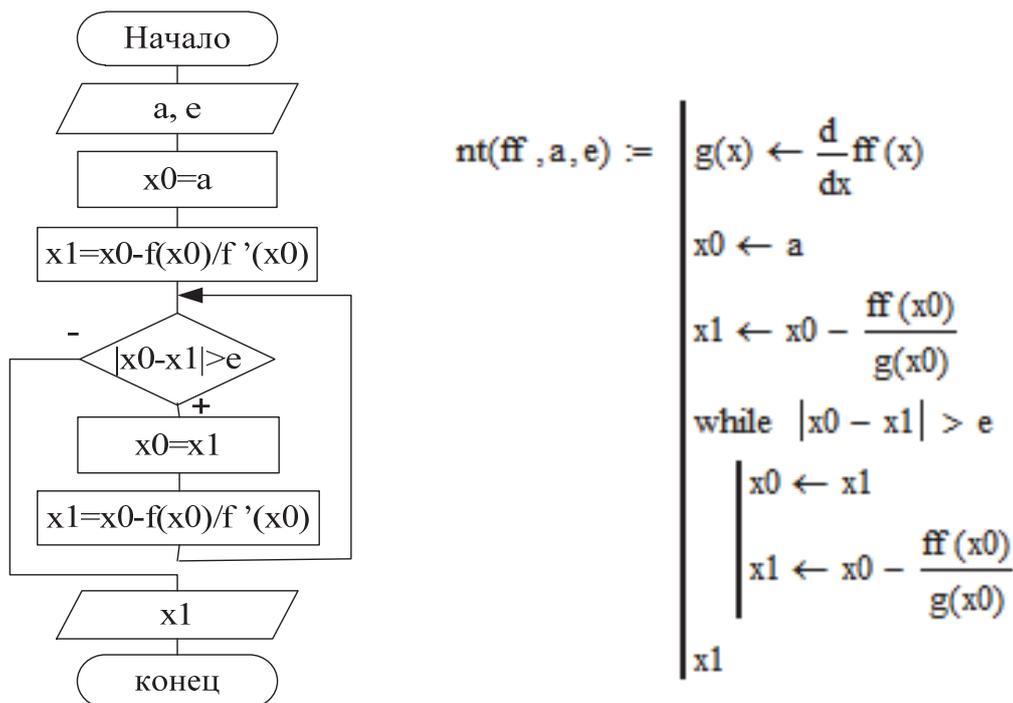
Рис. 3.15. Блок-схема алгоритма решения нелинейного уравнения (3.1) методом Ньютона и реализация алгоритма в MathCad [5, 11]
