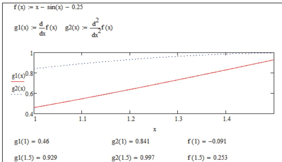
Рис. 3.16. Проверка условий сходимости метода
