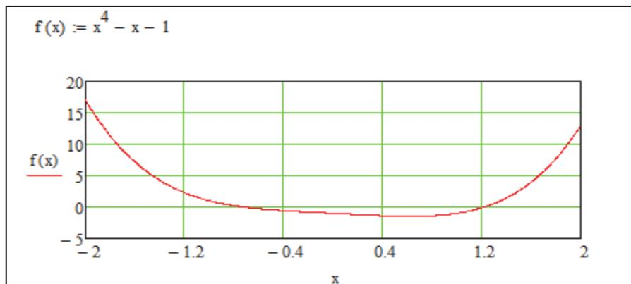
Рис. 3.1. Графическое отделение корней (1 способ)
