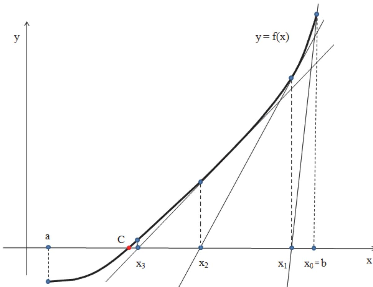
Рис. 3.14. Геометрическая интерпретация метода Ньютона
