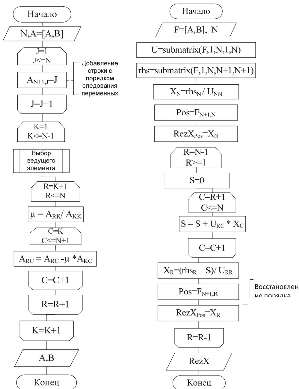
Рис. 4.7. Блок-схемы: а – алгоритма, реализующего прямой ход метода Гаусса с выбором ведущего элемента; б – алгоритма, реализующего обратный ход метода Гаусса с выбором ведущего элемента
