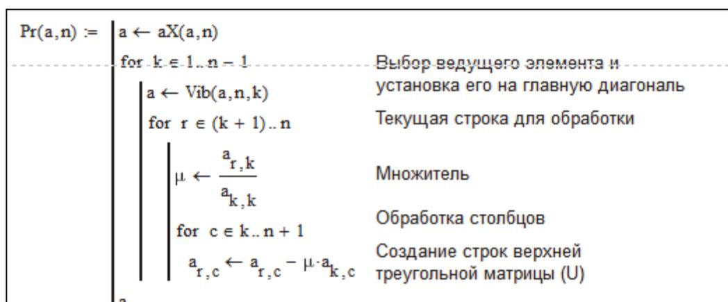
Рис. 4.10. Создание функции пользователя, реализующей алгоритм прямого хода метода Гаусса с полным выбором ведущего элемента
