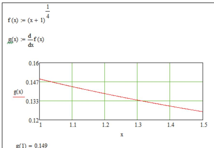
Рис. 3.10. Проверка условий сходимости метода простых итераций для (3.8)
