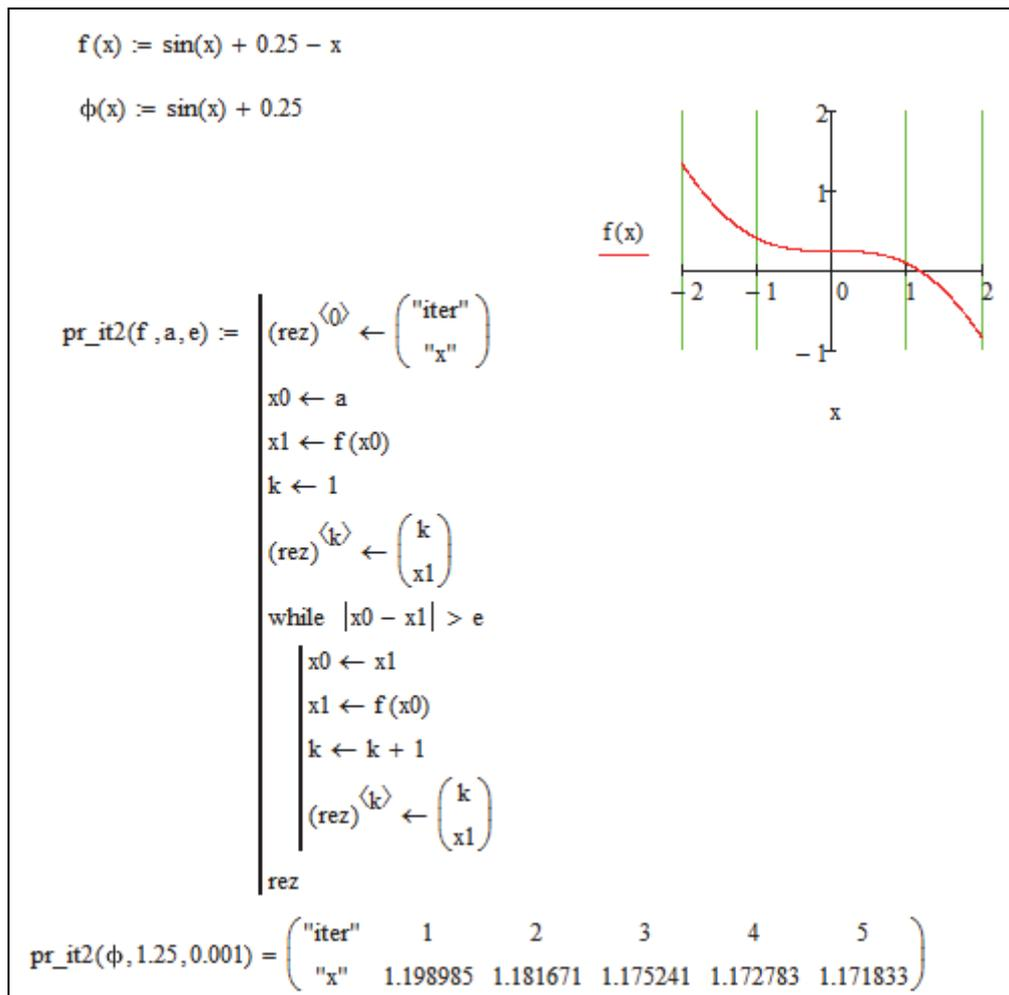
Рис. 3.9. Пример решения нелинейного уравнения методом простых итераций в MathCad с выводом получаемых на каждой итерации приближений
