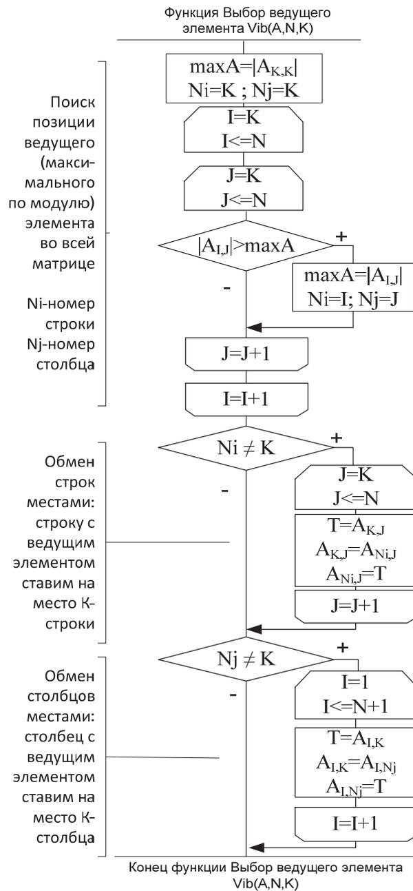
Рис. 4.8. Блок-схема алгоритма выбора ведущего элемента
