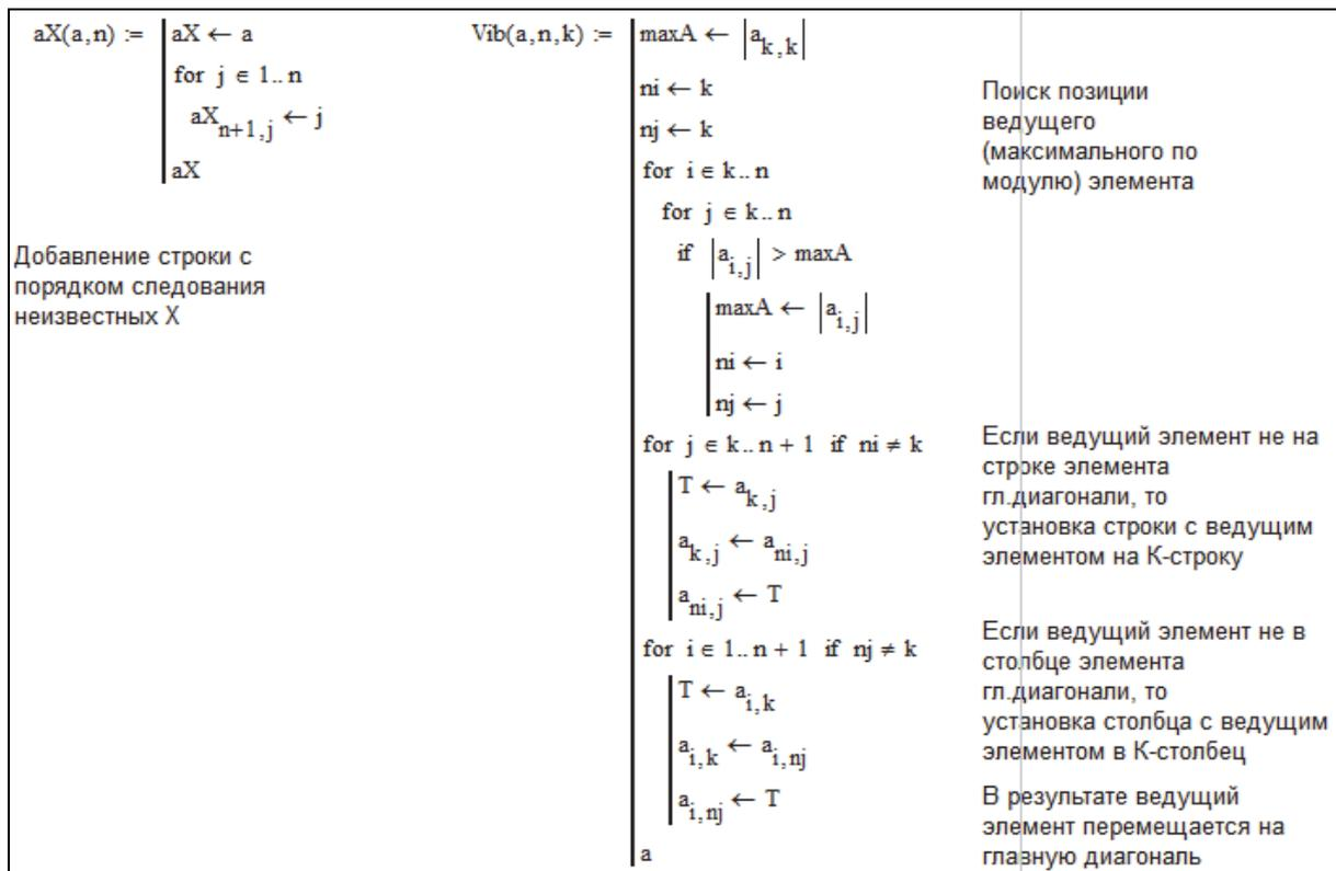
Рис. 4.9. Создание функции пользователя, реализующей алгоритм выбора ведущего элемента по всей матрице
