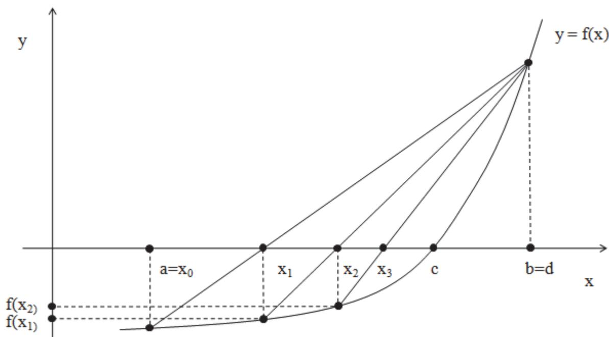
Рис. 3.19. Геометрическая интерпретация метода хорд
