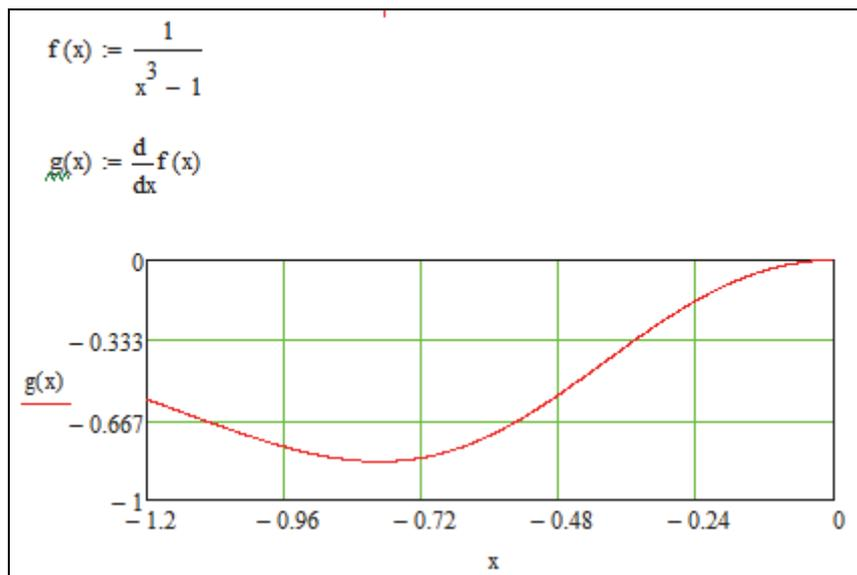
Рис. 3.11. Проверка условий сходимости метода простых итераций для (3.9)
