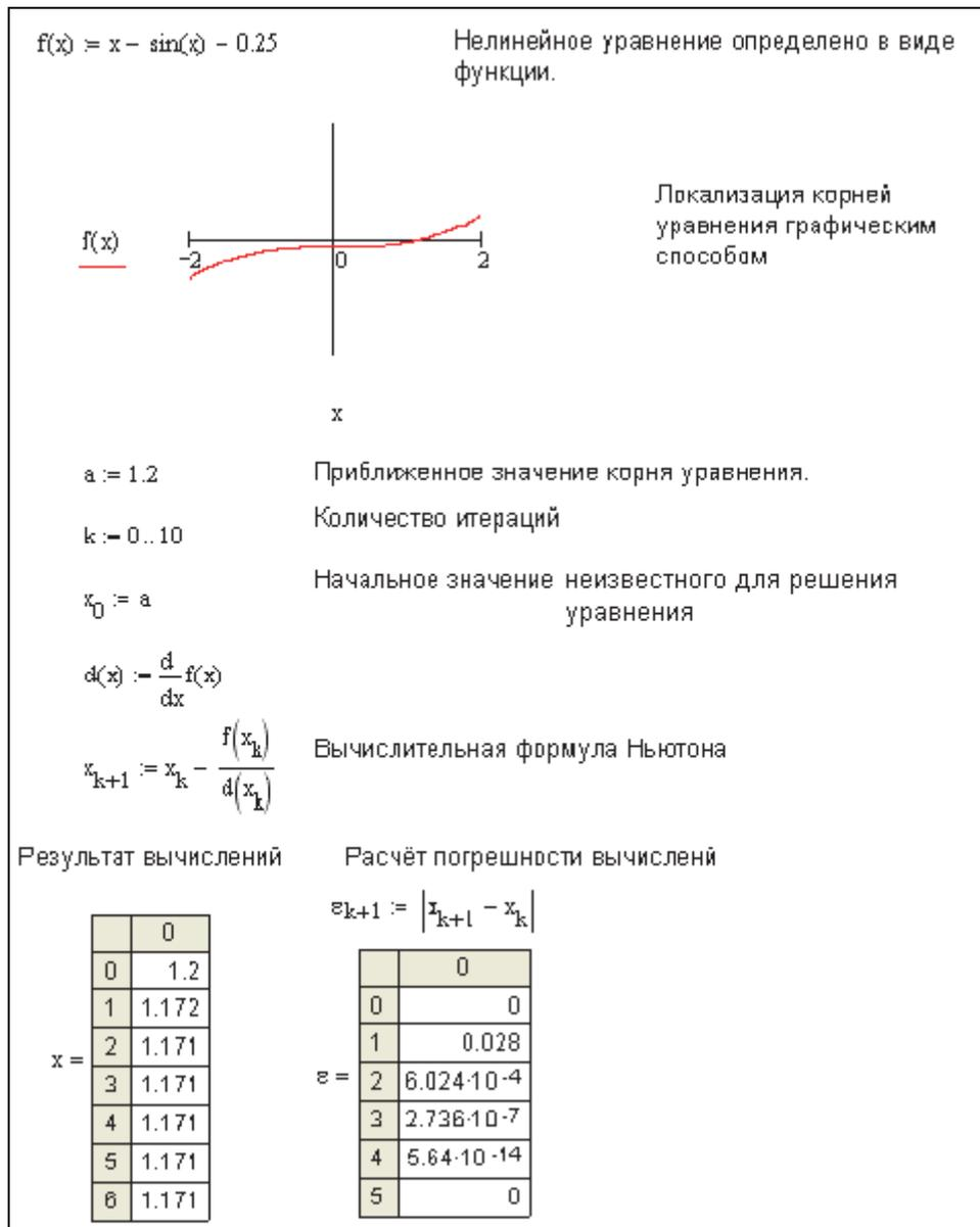
Рис. 3.29. Решение уравнения методом Ньютона
