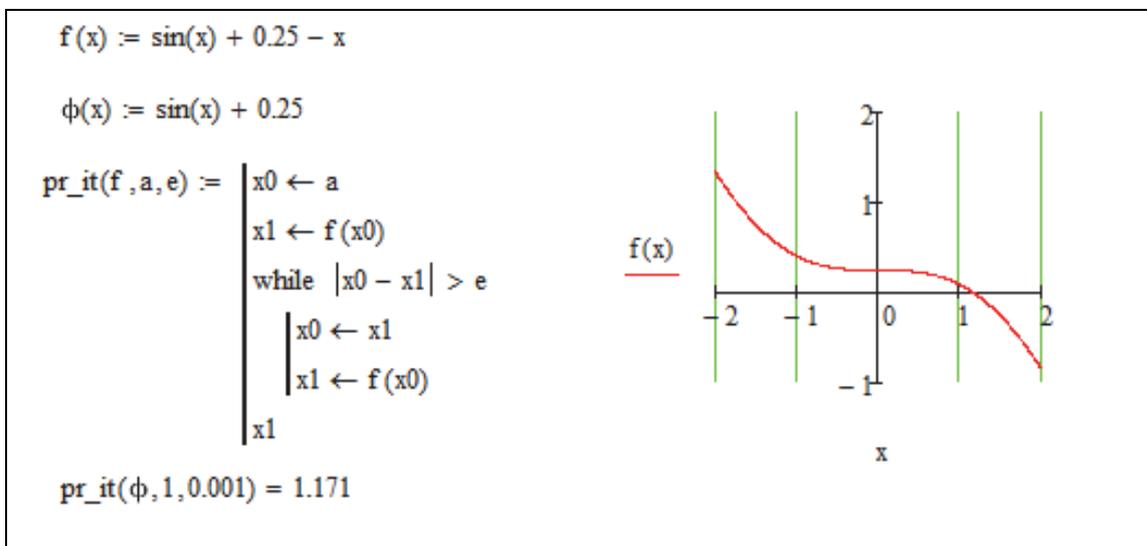
Рис. 3.8. Пример решения нелинейного уравнения методом простых итераций в MathCad
