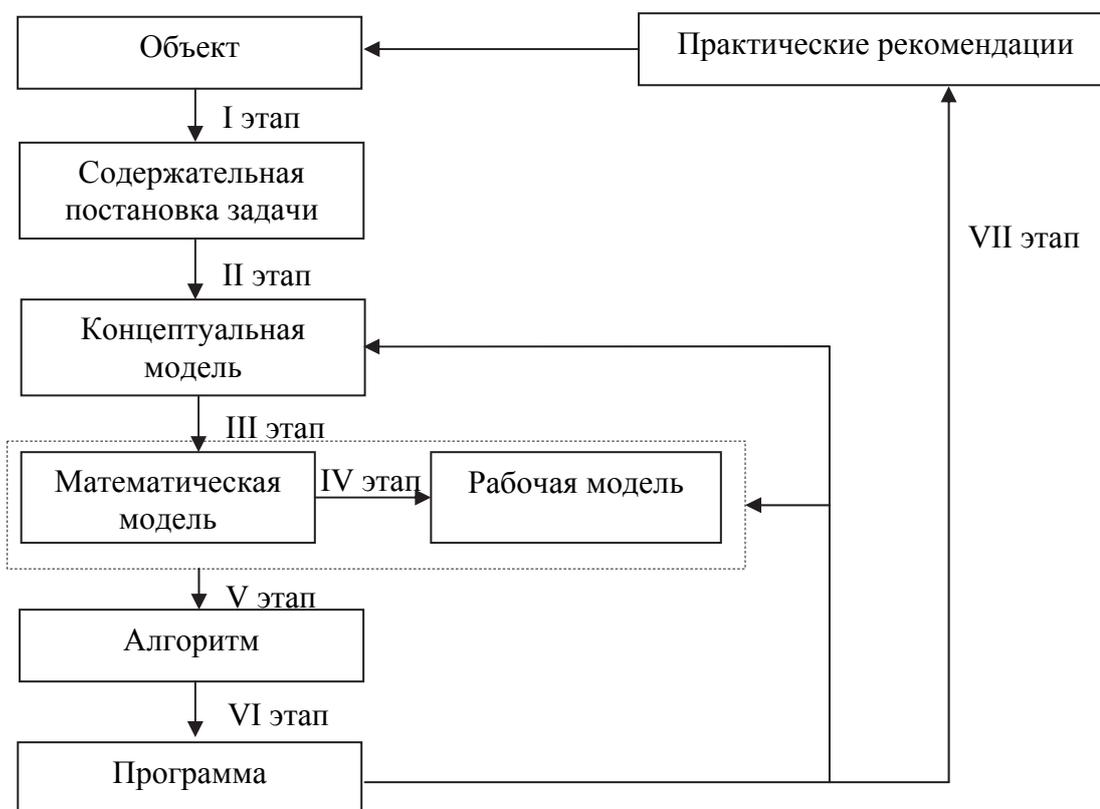
Рис. 1.1. Схема математического моделирования
