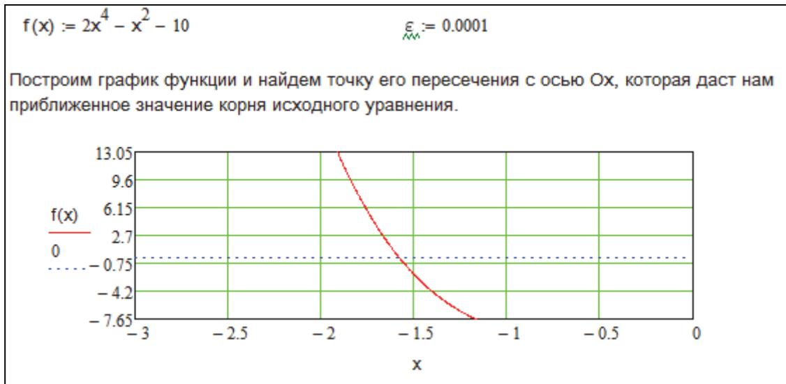
Рис. 3.25. Определение начального приближения отрезка
