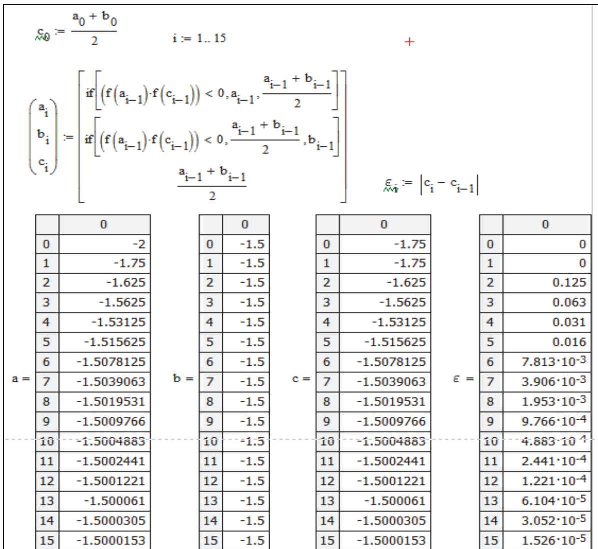
Рис. 3.27. Решение уравнения методом бисекции
