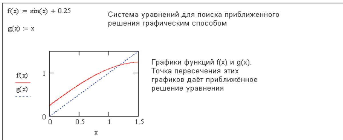
Рис. 3.23. Определение уравнения и графическое отделение корня
