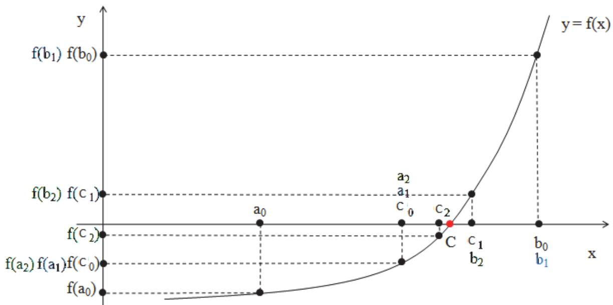
Рис. 3.3. Решение нелинейного уравнения методом половинного деления
