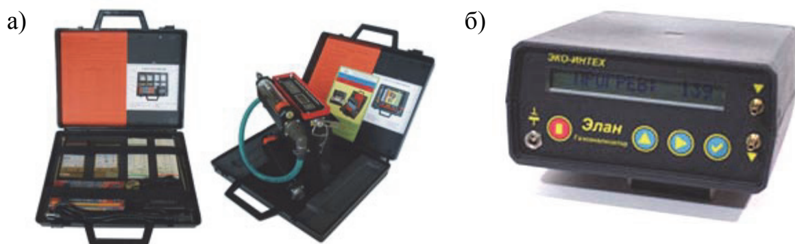
Рис. 3.1. Газоанализаторы: а – анализатор универсальный УПГК-ЛИМБ; б – портативный газоанализатор ЭЛАН
