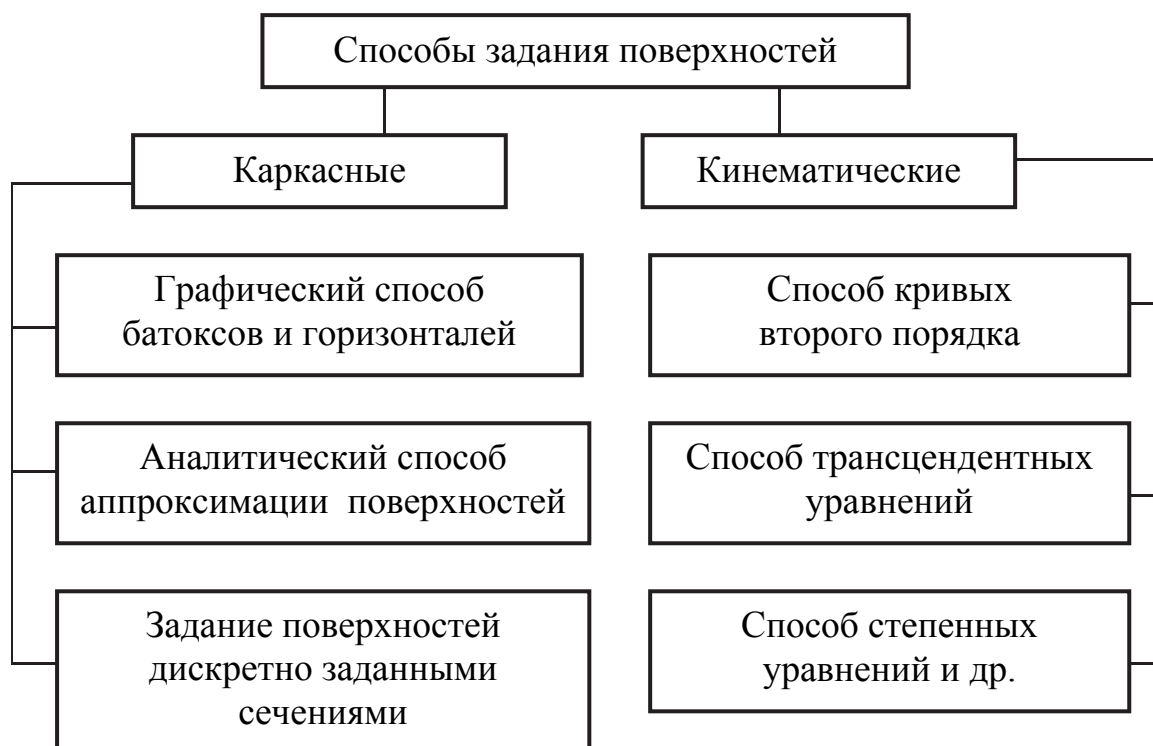
Рис. 5.3. Основные способы задания поверхностей в авиа- и ракетостроении
