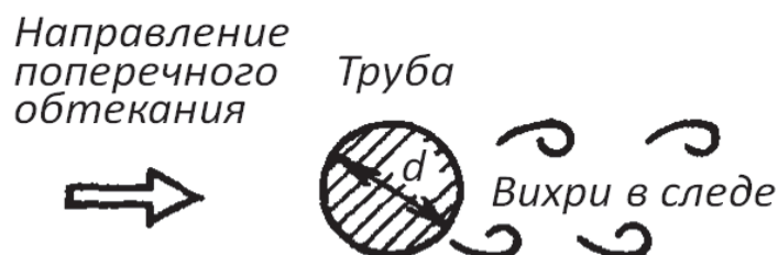
Рис. 3.5. Схема возникновения вихрей при поперечном обтекании трубы
