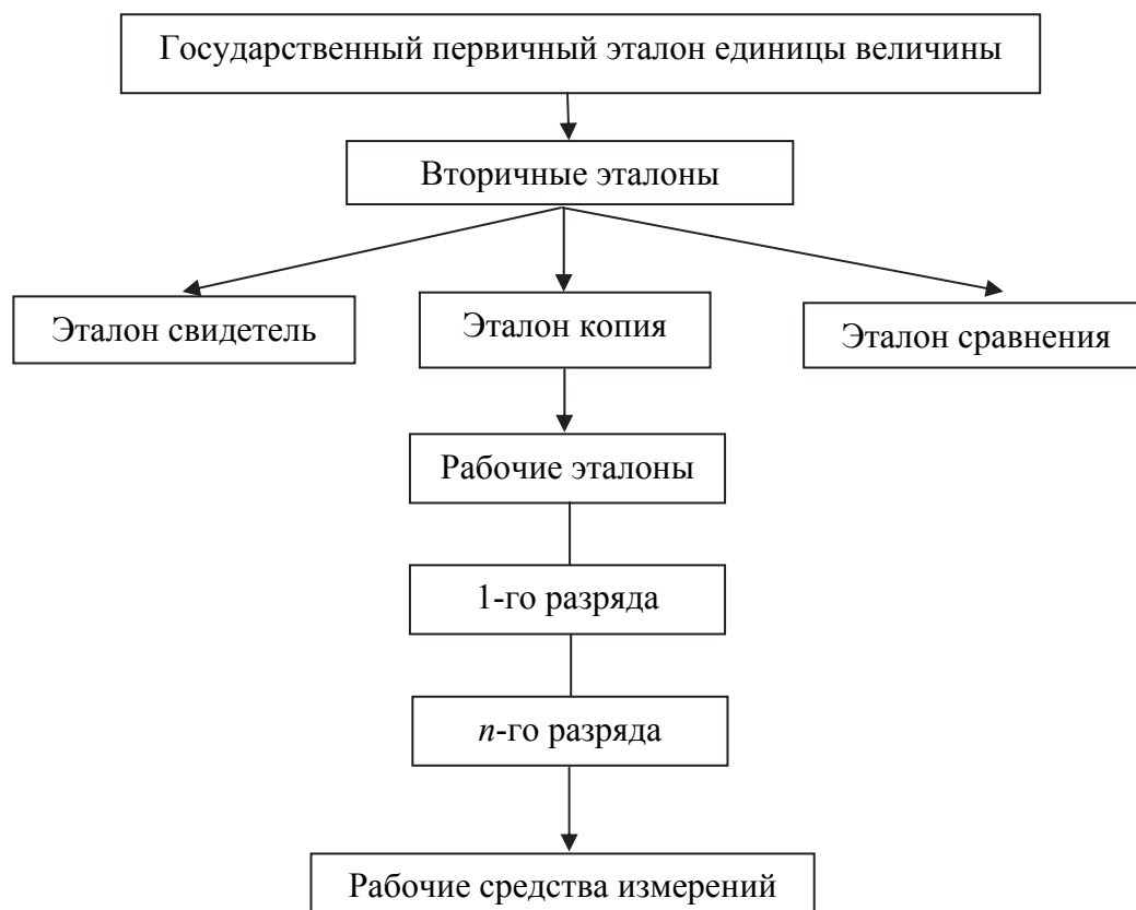
Рис. 1.1. Схема передачи размеров единиц
