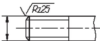
Рис. 5.15. Пример обозначения шероховатости наружной резьбы
