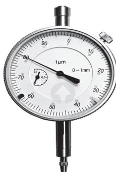
Рис. 10.10. Индикатор часового типа
