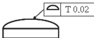
Рис. 5.38. Обозначение отклонения формы заданной поверхности
