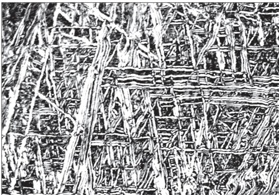
Рис. 2.3. Микроструктура титанового сплава ВТ-20, образованная при высокой скорости охлаждения расплавленного металла (X1000)
