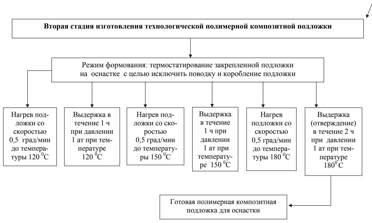
Рис. 6.51. Вторая стадия технологического процесса изготовления композитной подложки
