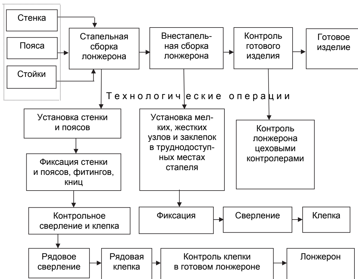
Рис. 5.3. Схема сборки клепаного лонжерона
