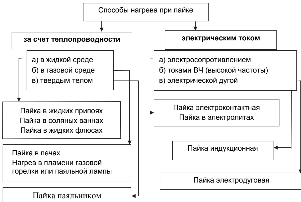
Рис. 4.7. Способы нагрева при пайке
