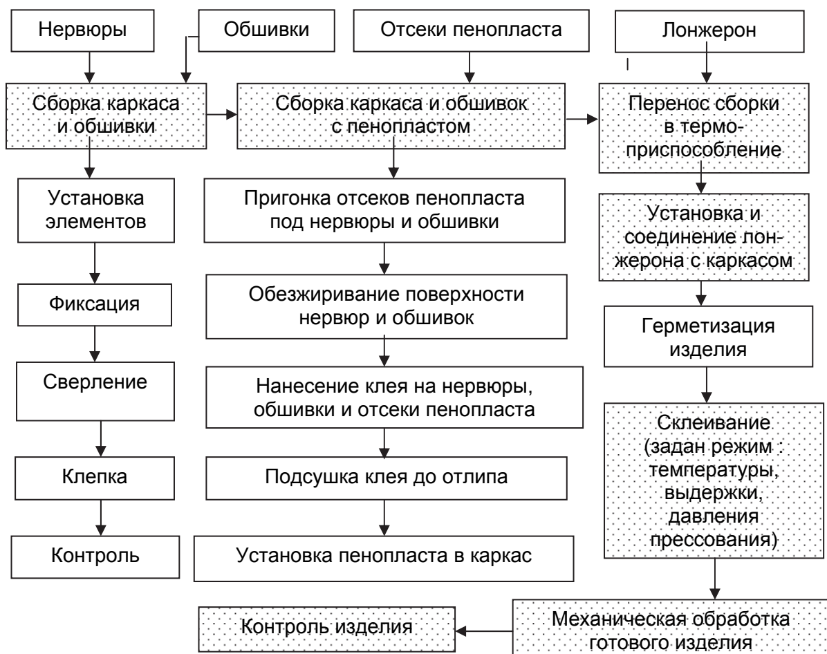
Рис. 5.11. Блок-схема сборки ХЧРН с пенопластовым наполнителем прессовым методом
