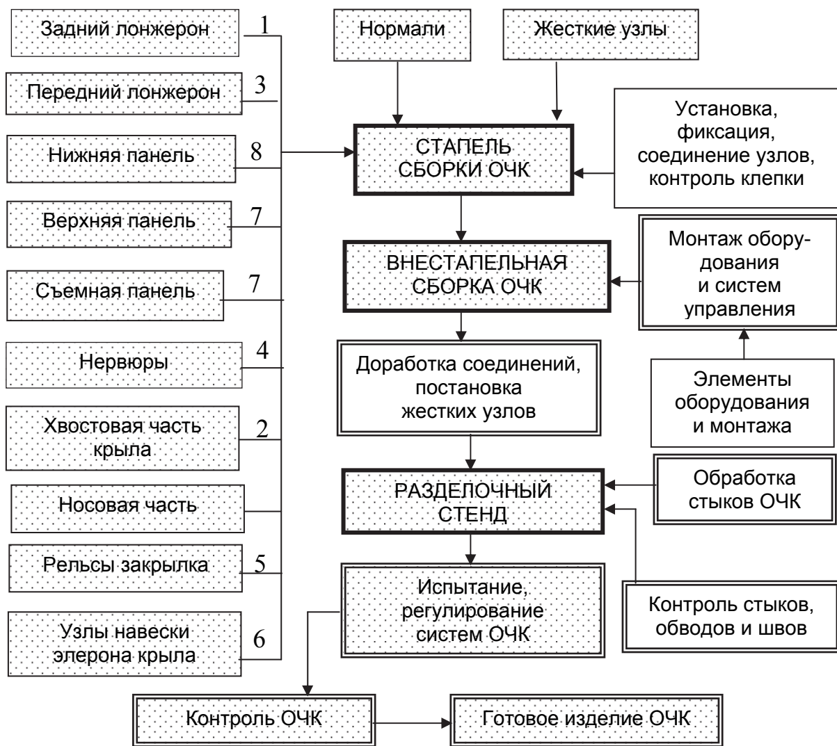
Рис. 6.4. Блок-схема сборки ОЧК
