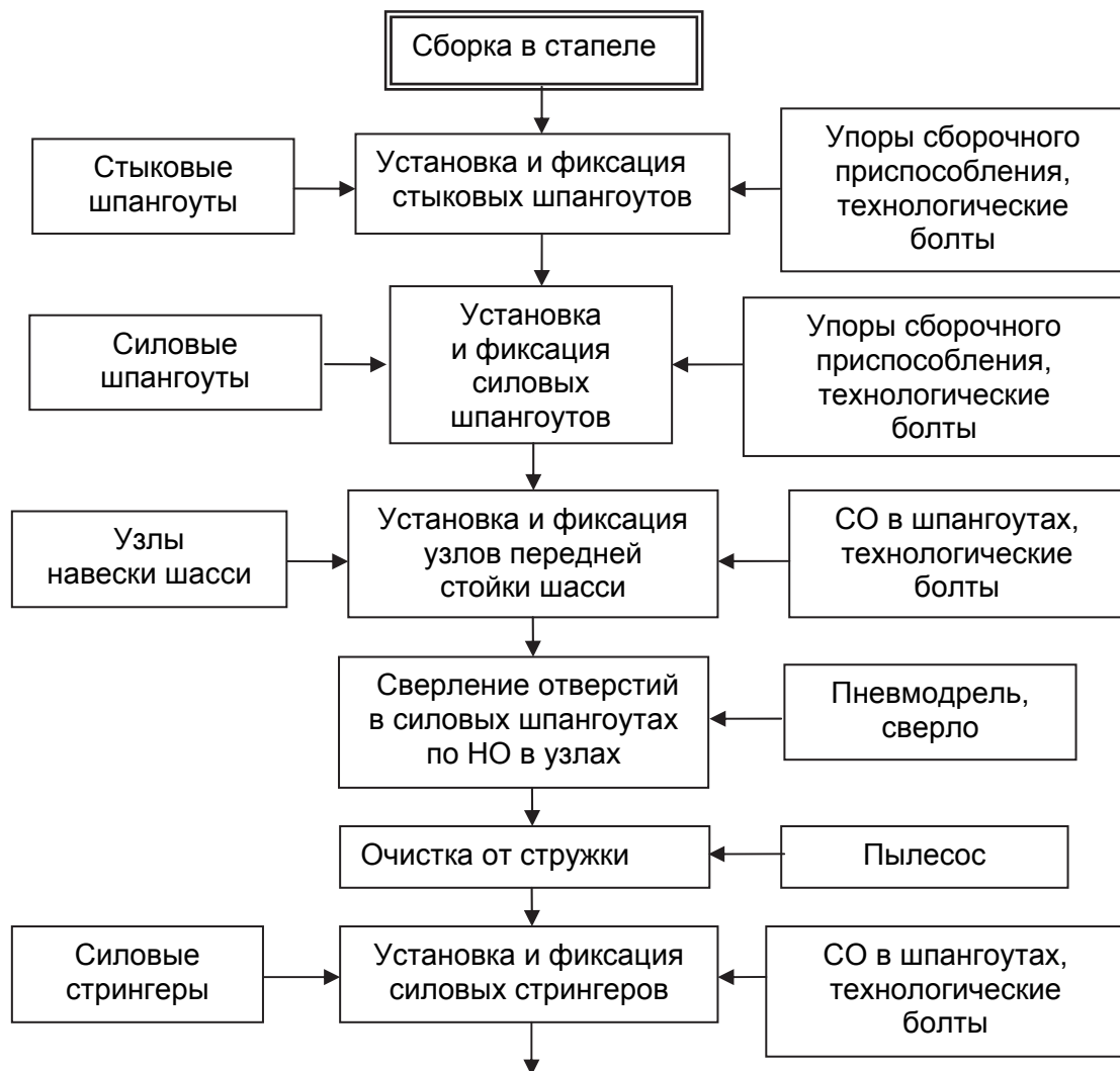
Рис. 6.8. Вариант схемы сборки носового отсека фюзеляжа (начало)
