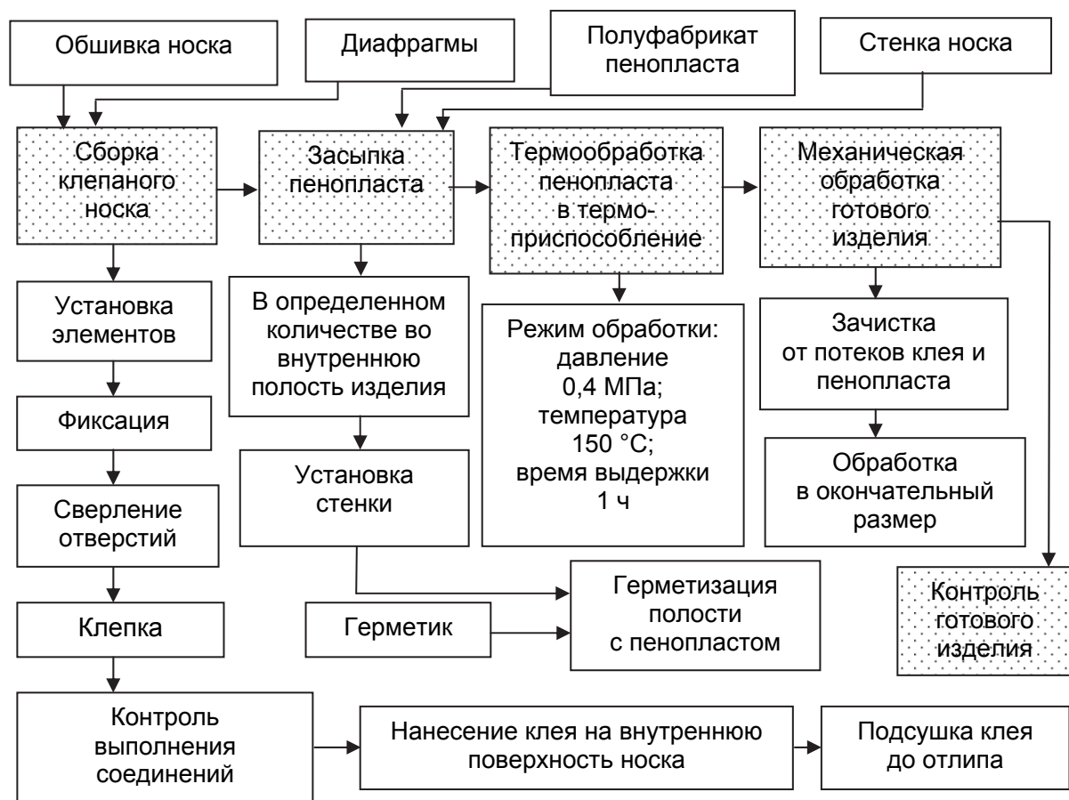
Рис. 5.12. Блок-схема процесса сборки носка стабилизатора беспрессовым методом
