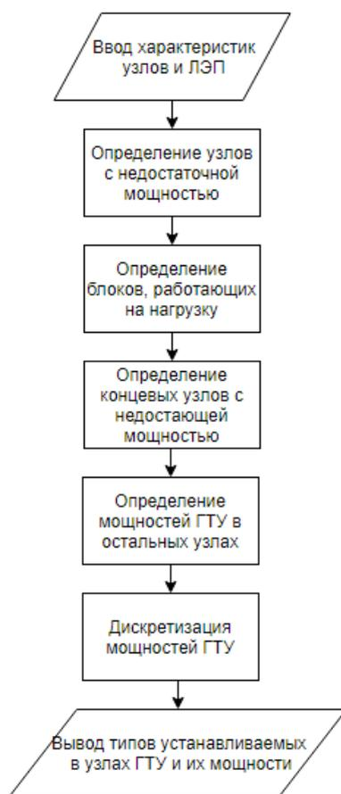
Рисунок 2 - Алгоритм вычисления мощностей
