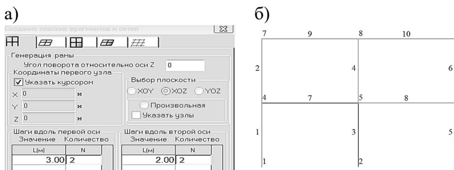
Рис. 1.39. Создание геометрической схемы плоской рамы:
