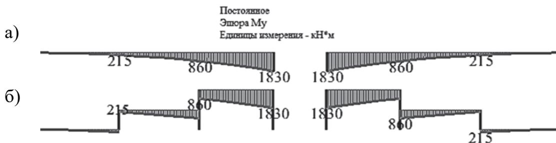
Рис. 4.11. Эпюры изгибающих моментов в фундаменте: а – стандартная расчетная схема; б – расчетная схема с абсолютно жесткими вставками
