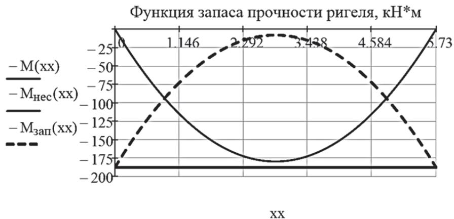
Функция коэффициента запаса прочности ригеля при постоянном армировании по длине ригеля
