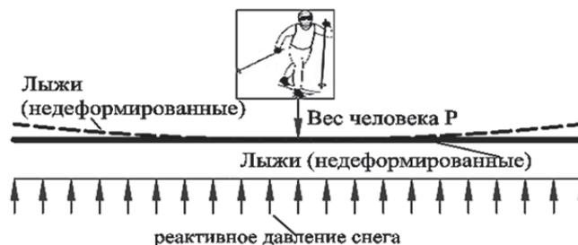
Рис. 4.3. Расчетная схема для лыж на реактивное давление снега
