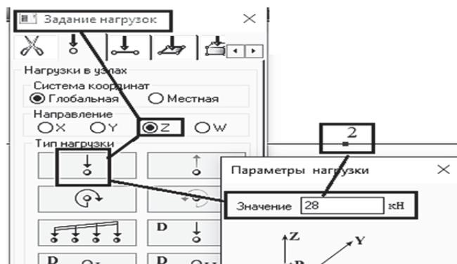
Рис. 1.50. Задание сосредоточенной нагрузки
