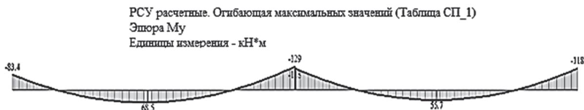
Рис. 3.21. Эпюры изгибающих моментов в ригеле от постоянной нагрузки
