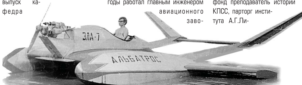
Первая работа молодых авиаконструкторов СКБ, которая была воплощена в реальность, – аппарат ЗЛА-7 «Альбатрос». Работа над ним велась в 1968–1971 годах. Активное участие в его создании принимали студенты В.В.Фролов, В.П.Котляров, С.И.Феоктистов. Ныне это известные преподаватели КнАГТУ.
