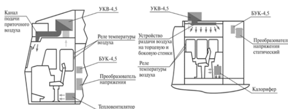
Рисунок 2 – Размещение блоков системы обеспечения микроклимата на тепловозе
