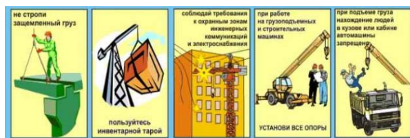
Рисунок 3 – Требования безопасности при погрузочно-разгрузочных работах
