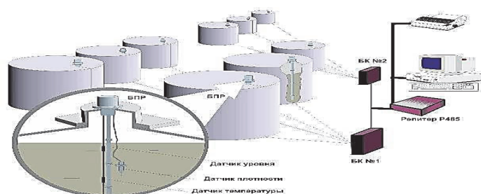
Рисунок 1 – Измерительная система основных параметров резервуара
