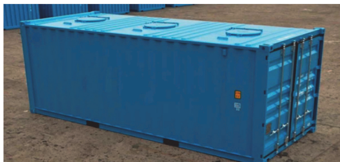
Рисунок 1 – Специальный контейнер для насыпных грузов
