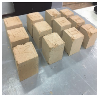
Рисунок 2 - Прессованные образцы из кека обожженные при 800 0 С
