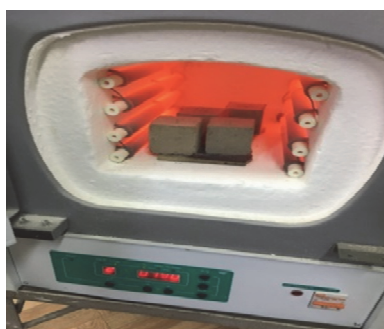
Рисунок 2 - Прессованные образцы из кека обожженные при 800 0 С
