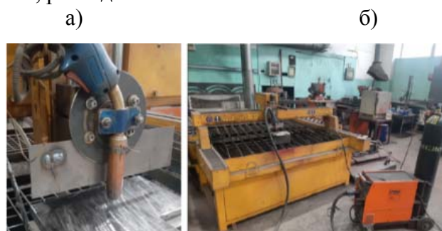
Рисунок 1 – Кронштейн крепления сварочной горелки (а) и общий вид комплектации станка для аддитивной наплавки (б)
