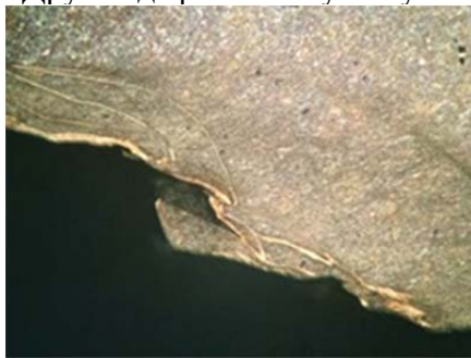
Рисунок 6 - Деформация микроструктуры (наклеп зубчатого колеса №2)
