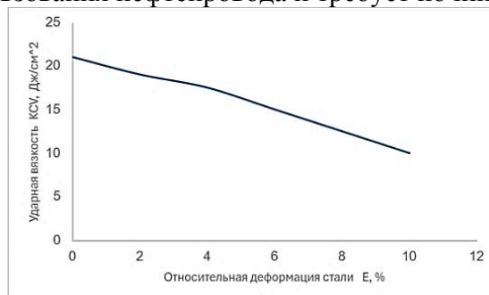
Рисунок 2 – Относительная деформация стали в зоне механического повреждения
