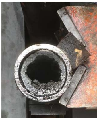
Рисунок 1 – Образование кокса в трубе змеевика
