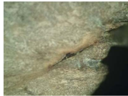
Рисунок 7 - Задир на поверхности зубчатого колеса №2
