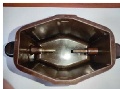
Рисунок 1 – Измерительная ячейка для трансформаторного масла
