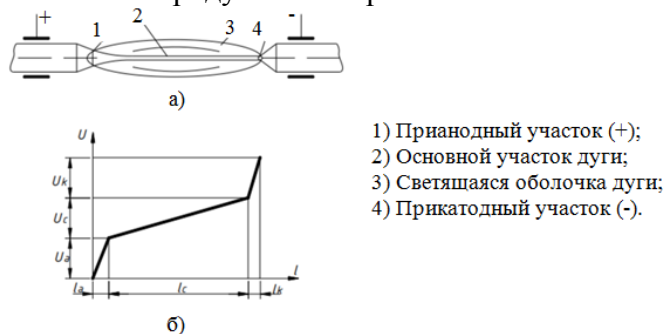
Рисунок 3 – Электрическая дуга (а) постоянного тока и распределение напряжения (б) на ее элементах
