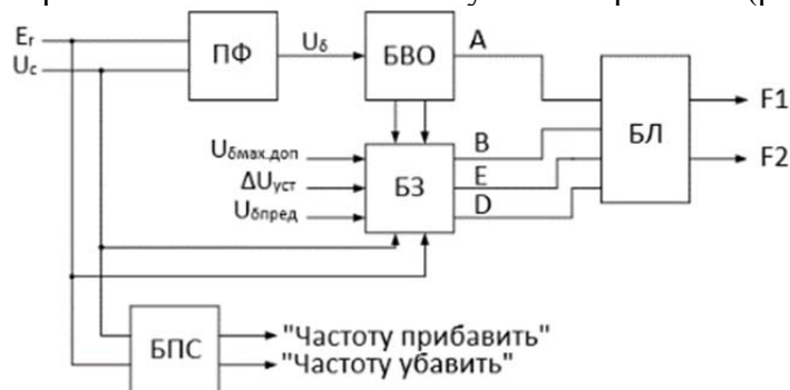
Рисунок 2 – Структурная схема автоматического синхронизатора типа СА-1
