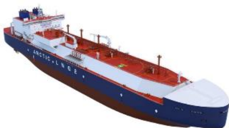
Рисунок 3 – Танкер-газовоз класса Arc7
