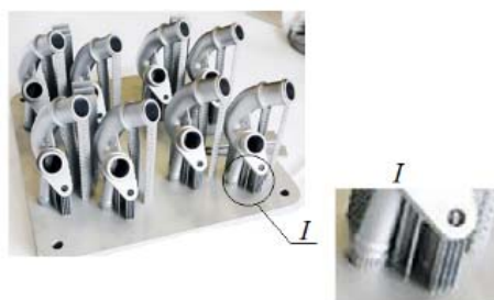
Рисунок 1 – Плита построения с построенным на ней изделием без поддерживающих структур (а) и с поддерживающими структурами (б)
