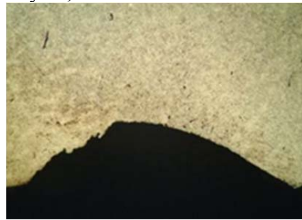
Рисунок 5 - Задир на поверхности зубчатого колеса №1
