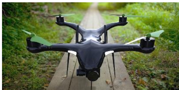
Рисунок 2 – Пример квадрокоптера с обтекаемой формой корпуса
