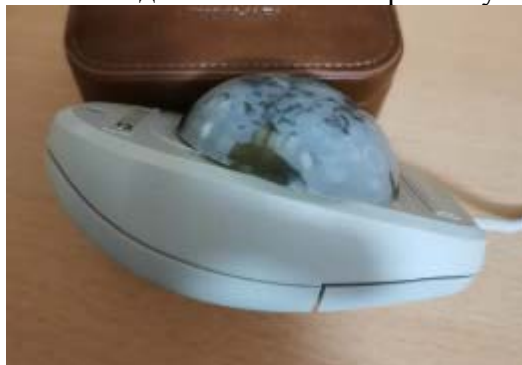
Рисунок 1 – Действующий макет джойстика
