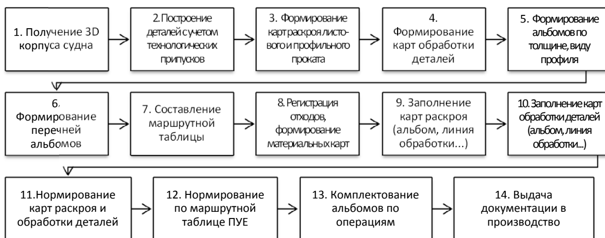
Рисунок 1 – Блок-схема процесса формирования технологической документации
