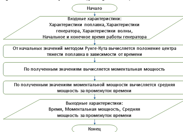
Рисунок 1 – Алгоритм расчёта характеристик волнового поплавка
