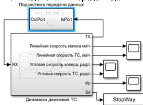
Рисунок 2 – Имитационная модель движения транспортного средства с подсистемой передачи данных
