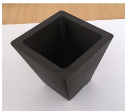
Рисунок 3 – 3D модель для отработки режимов печати гидростатически плотных изделий
