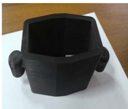
Рисунок 2 – Изготовленная измерительная ячейка для трансформаторного масла
