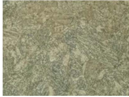
Рисунок 3 - Внутреннее строение микро-структуры зубчатого колеса №2
