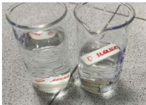
Рисунок 2 – Сферопластики, с содержанием наполнителя 10 % (слева) и 15 % (справа)
