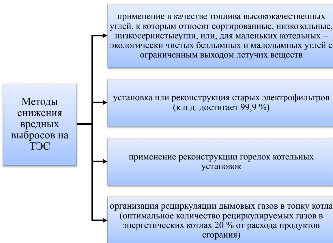
Рисунок 1 – Классификация методов снижения вредных выбросов с дымовыми газами ТЭС
