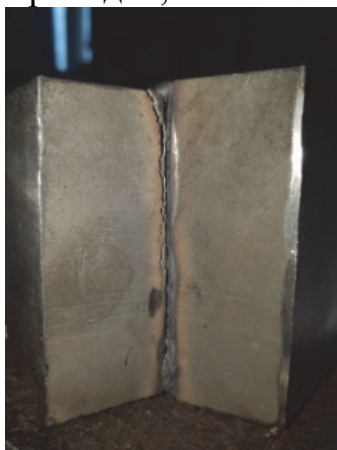
Рисунок 3 – Сварка после 9 проходов, вид со стороны корня шва
