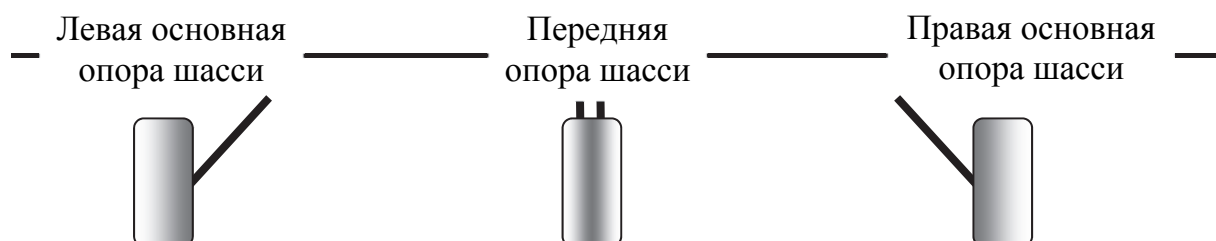
Рисунок 1 – Структурная схема расчета надежности шасси
