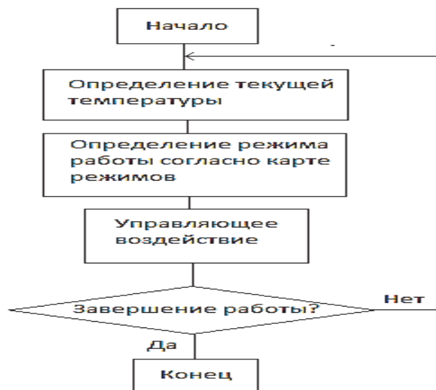
Рисунок 1. Функциональная схема алгоритма управления электронно-управляемого термостата совместно с электрическим жидкостным насосом
