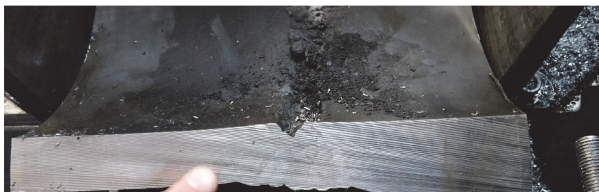
Рисунок 1 – Срез трубы поперек сварного шва
