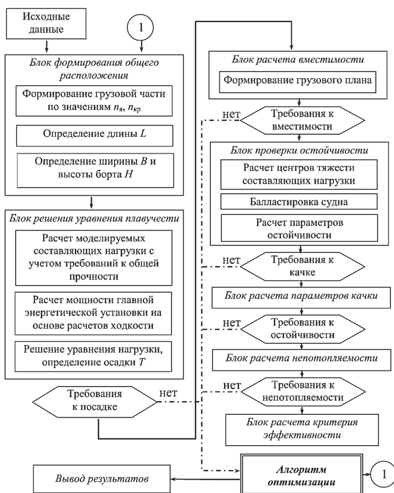
Рисунок 2 – Обобщенная математическая модель оптимизационного проектирования контейнеровоза
