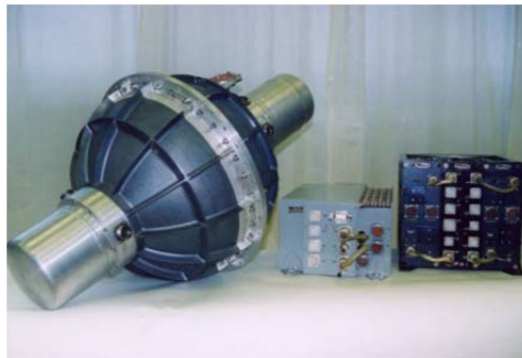
Рисунок 6 – Двухступенной гиросиловой стабилизатор-гиродин
