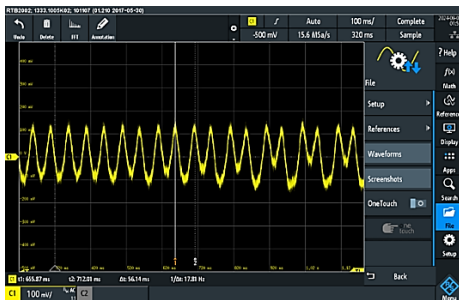
Рисунок 2 – Скриншот осциллограммы интерференционного сигнала. Режим нагрузки пьезоэлемента: -частота - 100 Гц; - амплитуда – 3,0 В
