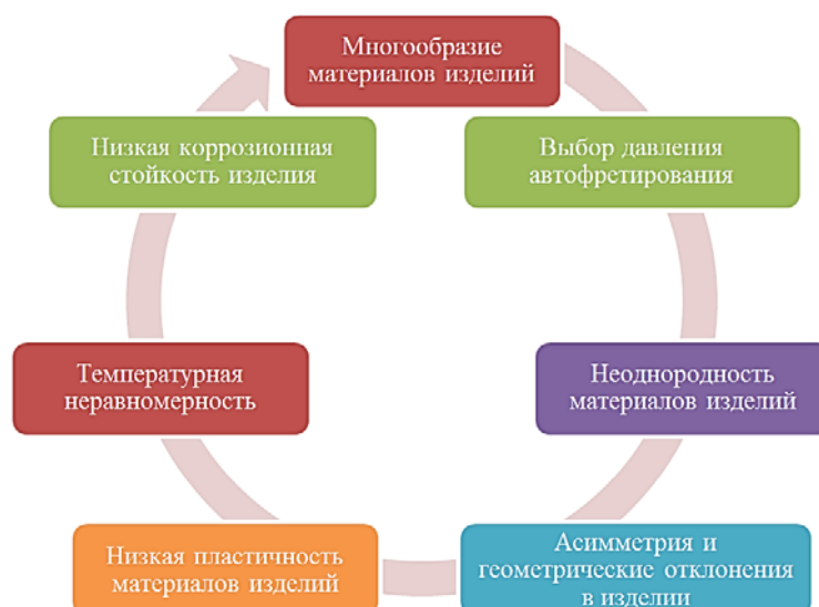
Рисунок 1 – Некоторые трудности при реализации процесса гидравлического автофреттирования
