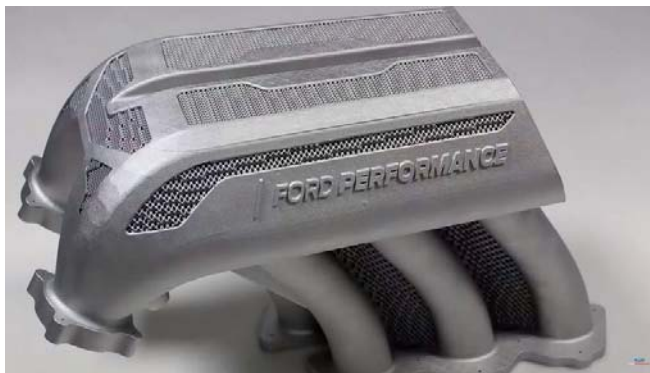
Рисунок 2 – Впускной коллектор, изготовленный на 3Д принтере
