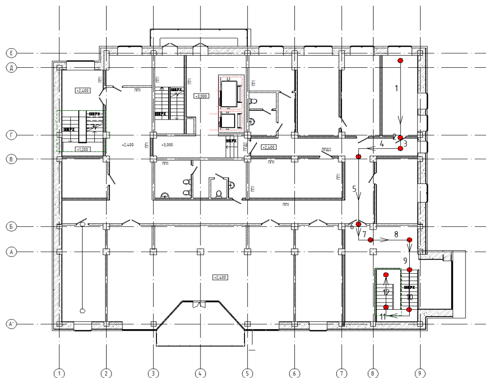
Рисунок 11 – Схема эвакуации наиболее удаленной точки 2 этажа
