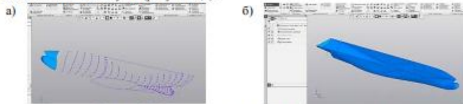
Рисунок 2 – Построение поверхности по сети кривых: а – сеть кривых; б – поверхность корпуса в КОМПАС-3D
