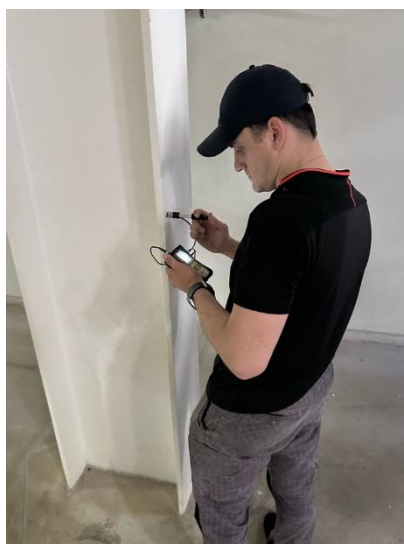
Фото Е.1 – Проведение контроля по определению химического состава элементов.
