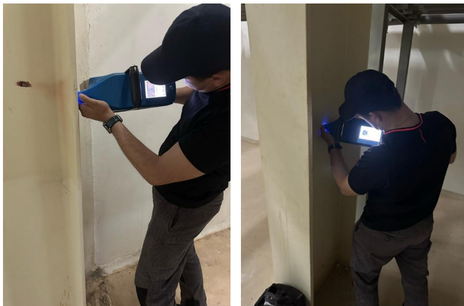
Фото Е.1 – Проведение контроля по определению химического состава элементов.
