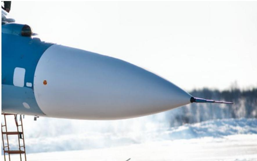
Рисунок 1.1 – Носовой обтекатель самолета истребителя
