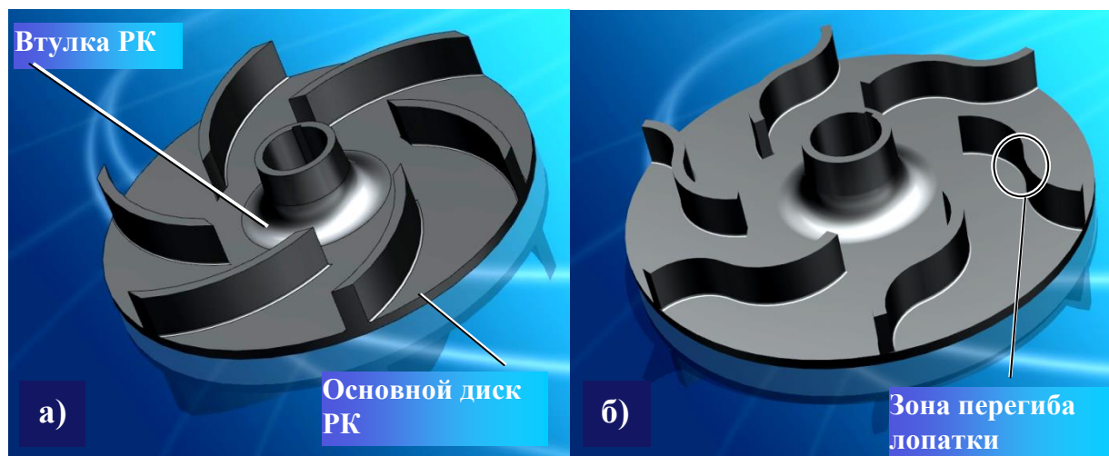
Рисунок 3 – Варианты рабочего колеса МЦН с 2-мя типами лопаток а – цилиндрические лопатки, б – S-образные лопатки
