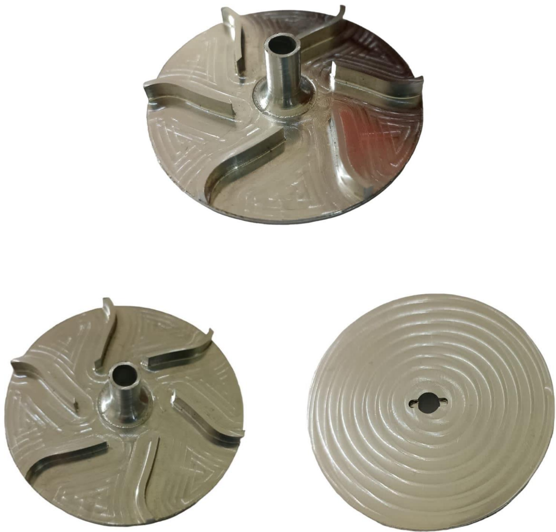
Рисунок 19 – Фото выполненного РК с помощью разработанного ТП и УП
