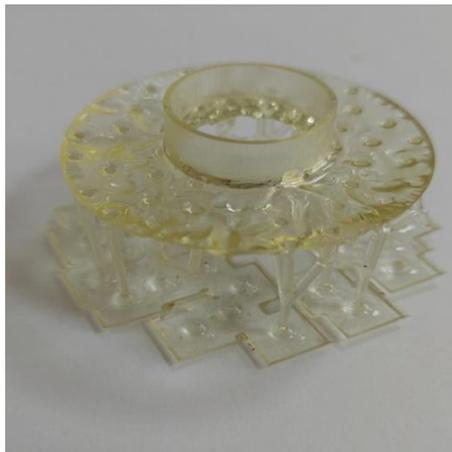
Рисунок 8 – Деталь, распечатанная на подержках
