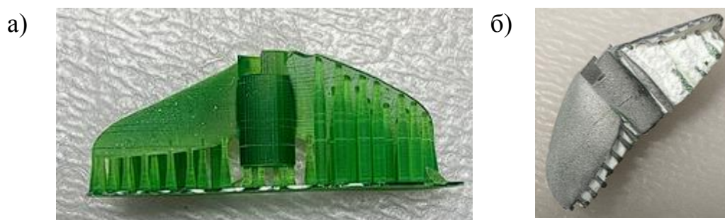
Рисунок 1 – Мастер модель и отливка винта для гоночной лодки. а – мастер модель; б – отливка
