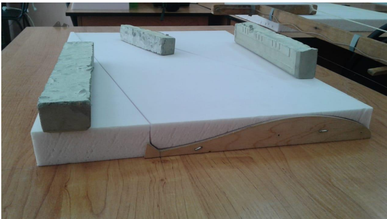
Рисунок 7 – Закрепление шаблона на заготовке
