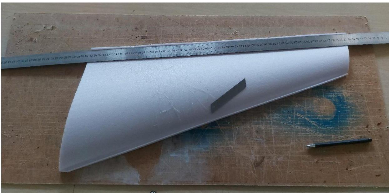
Рисунок 9 – Подрезка кромок крыла
