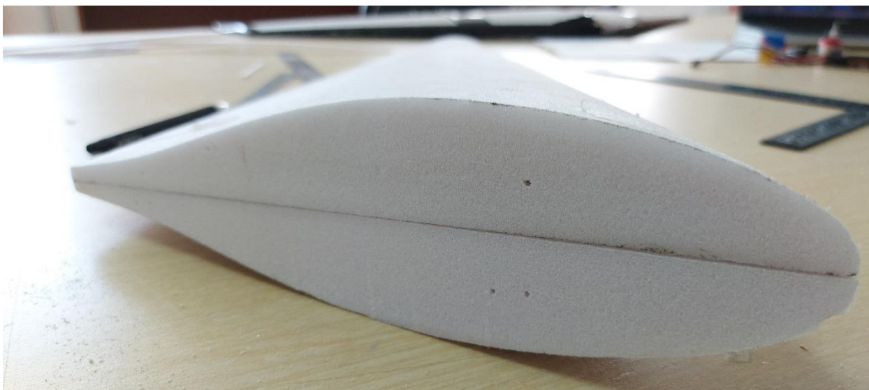
Рисунок 10 – Профилирование передней кромки консолей
