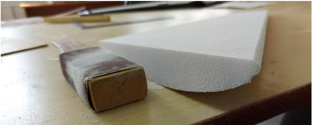
Рисунок 11 – Обработка нижней поверхности передней кромки
