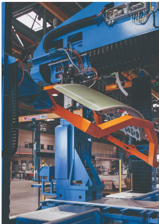
Рисунок 13 – Установка для клепки двери или люка
