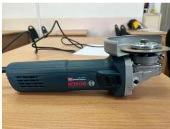
Рисунок 6.2 – Используемая углошлифовальная машина
