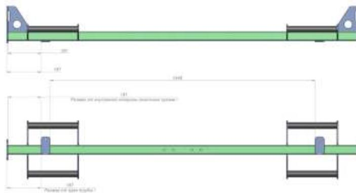
Рисунок 1.5 – Технологические размеры балки в сборе
