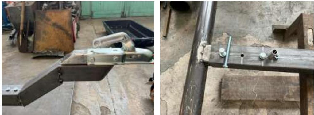
Рисунок 6.8 – Болтовые соединения деталей
