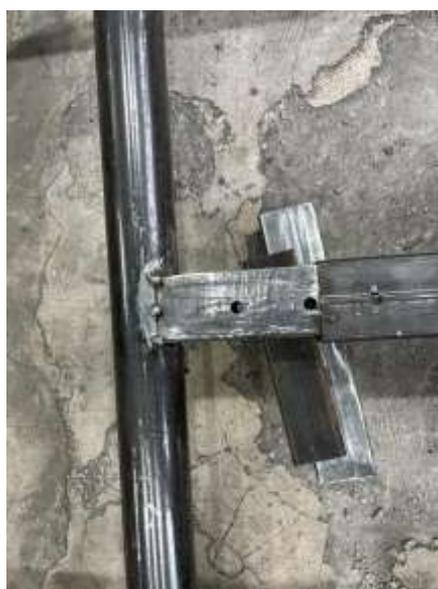
Рисунок 6.6 – Детали собранные на прихватках с механической зачисткой поверхности
