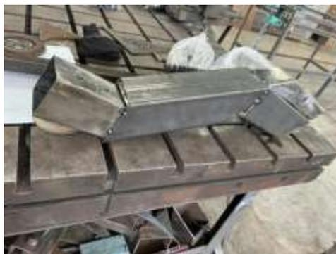
Рисунок 6.5 – Собранный узел на прихватках с установкой на сварочном столе.
