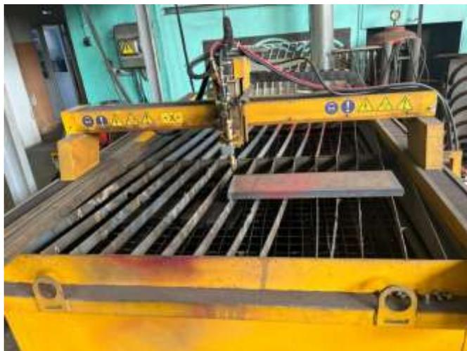
Рисунок 6.1 – Раскрой заготовок на плазменном станке
