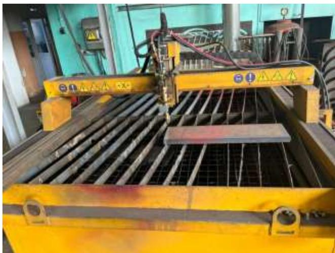
Рисунок 2.8 – Станок плазменной резки МТР-СГ
