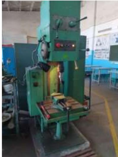
Рисунок 6.3 – Вертикально–сверлильный станок
