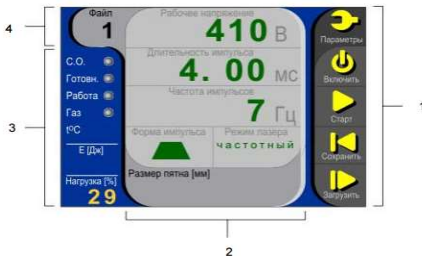
Рисунок 2.6 – TFT-панель пульта управления.
