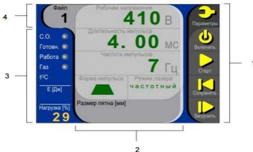
Рисунок 2.6 – TFT-панель пульта управления.
