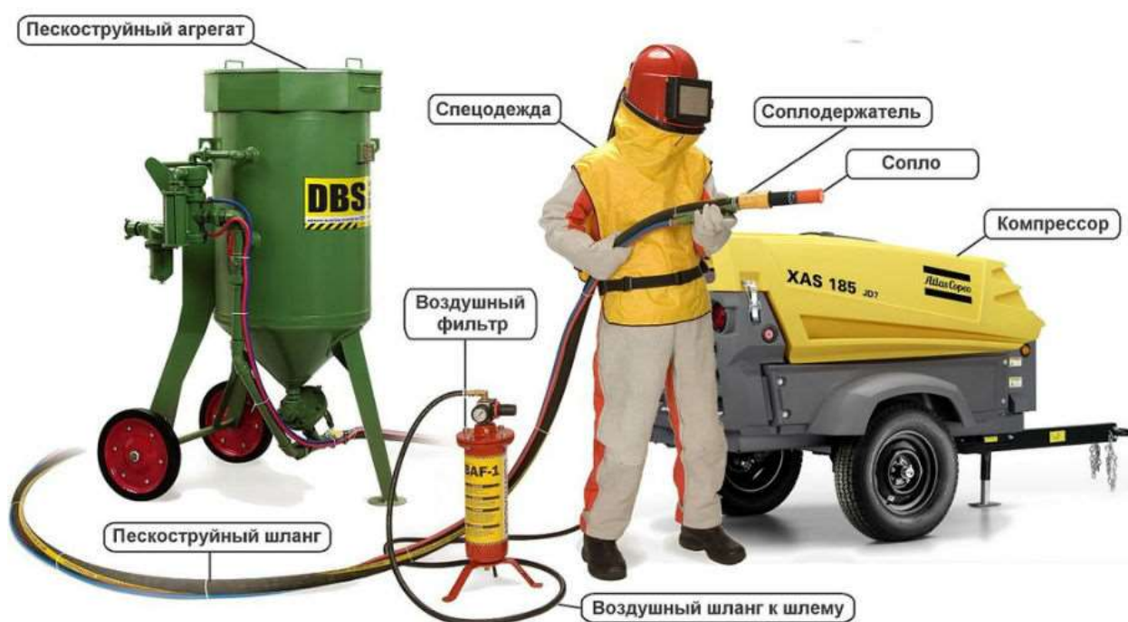
Рисунок 1.1 – Мобильное оборудование для пескоструйной обработки
