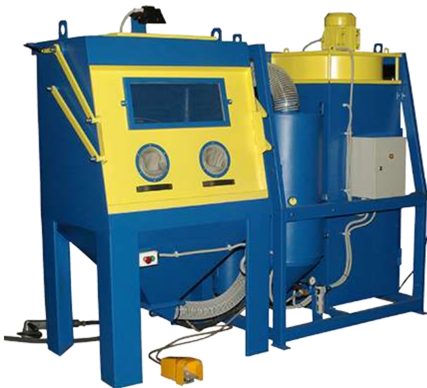
Рисунок 1.2 – Установка пескоструйной обработки
