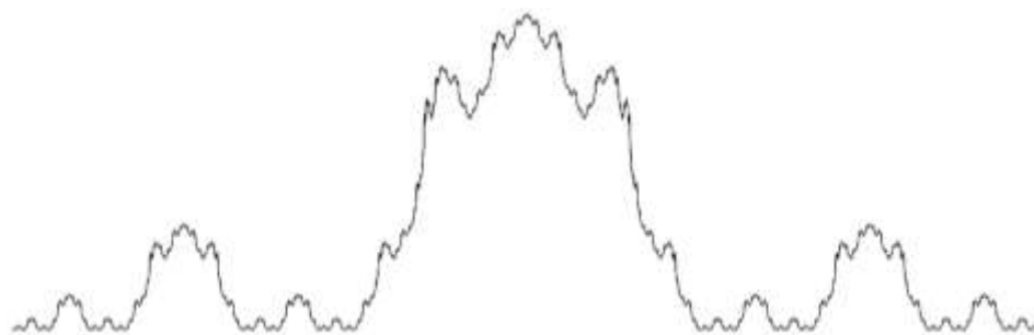
Рис. 3. Модель канторовского профиля шероховатости поверхности
