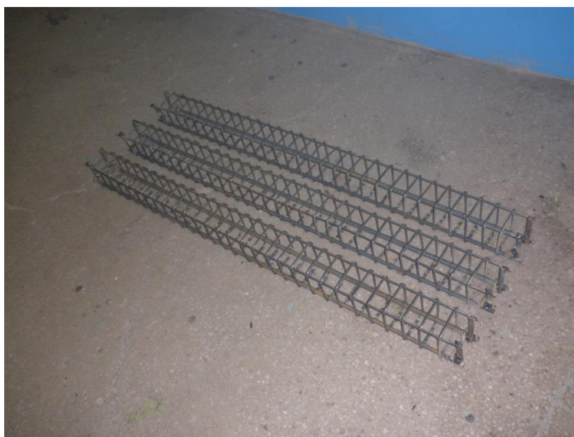
Рис. 1. Каркас железобетонной балки из высокопрочного бетона
