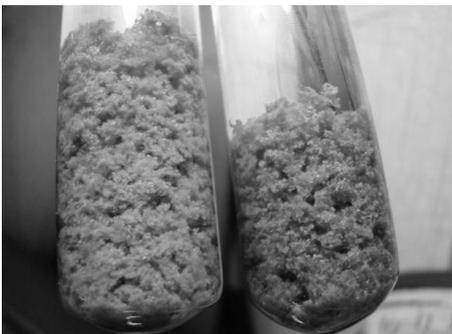
Теперь можно изучить свойства полученного соединения. Внесите немного его в ложку или на металлической пластинке в пламя и нагревайте в течение нескольких минут. Постепенно зеленый цвет сменится черным.
