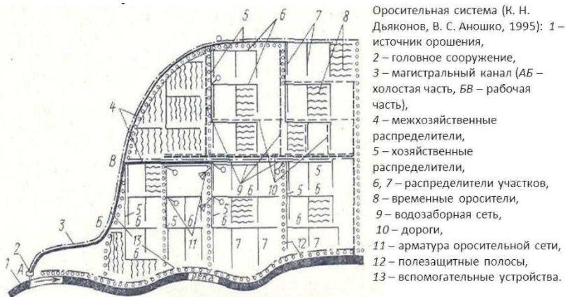
Рисунок 5 – Устройство оросительной системы
