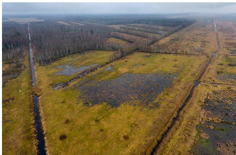
Рисунок 11 – Осушительная система на территории болота
