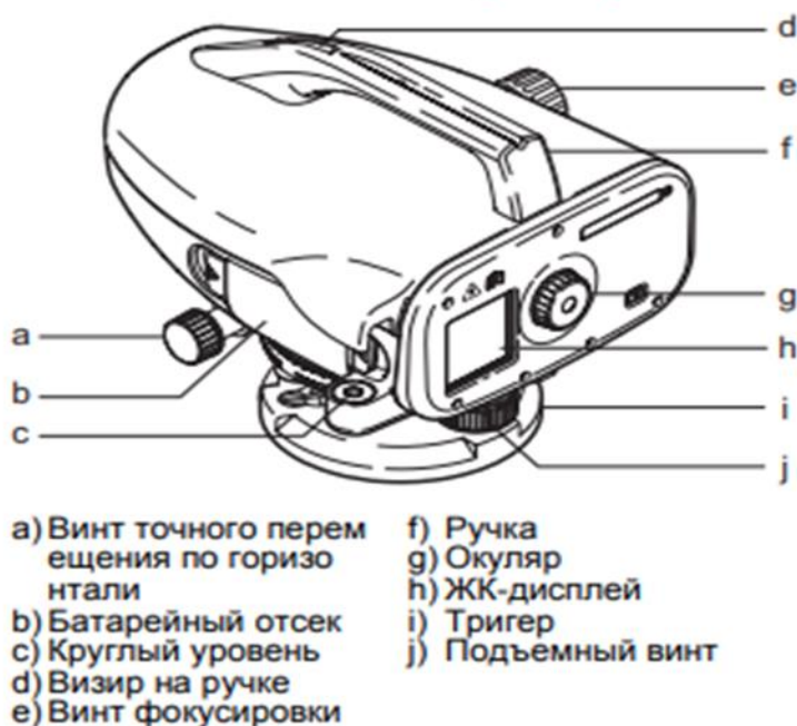
Рисунок 3. Общий вид и расположение основных устройств цифрового нивелира
