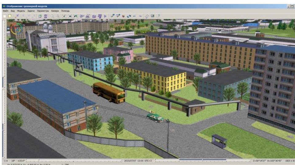
Рисунок 28 - 3D-модель района города с использованием разнообразного отображением стен с помощью семантики типа «Ссылка на графический файл»
