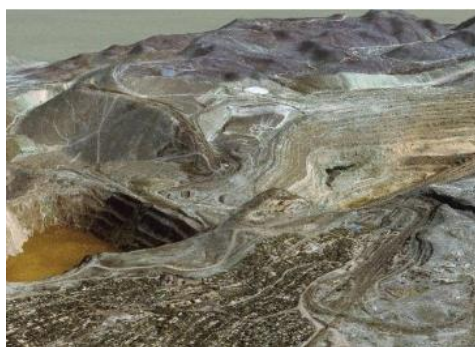
Рисунок 25 - Трехмерная модель на основе цифрового снимка и матрицы высот
