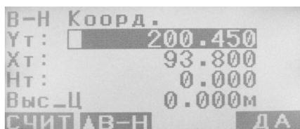
Рисунок 9 – Ввод координат выносимой в натуру точки
