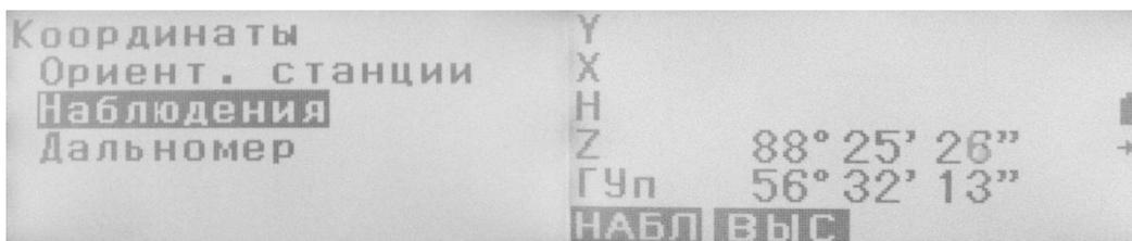
Рисунок 13 - Режим работы Координаты может быть использован при выносе в натуру сетки строительных осей возводимых зданий
