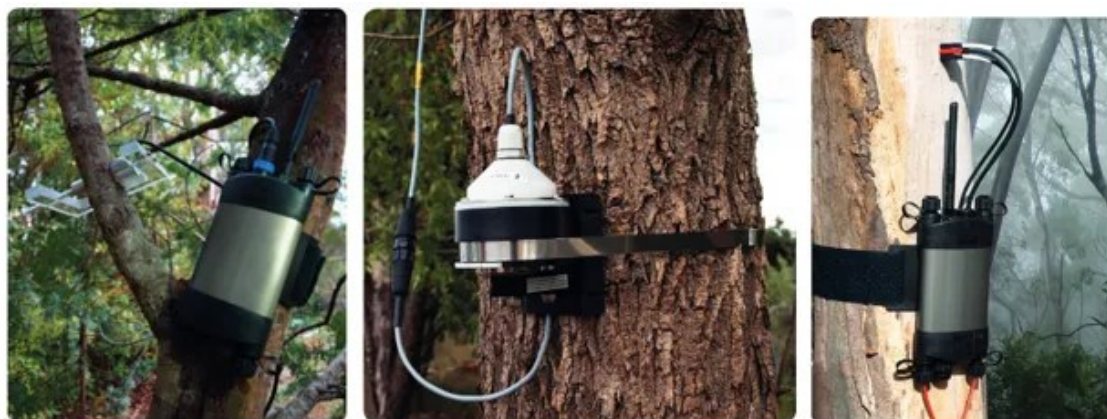
Рисунок 8 – Наземные сенсоры в сети IoT
