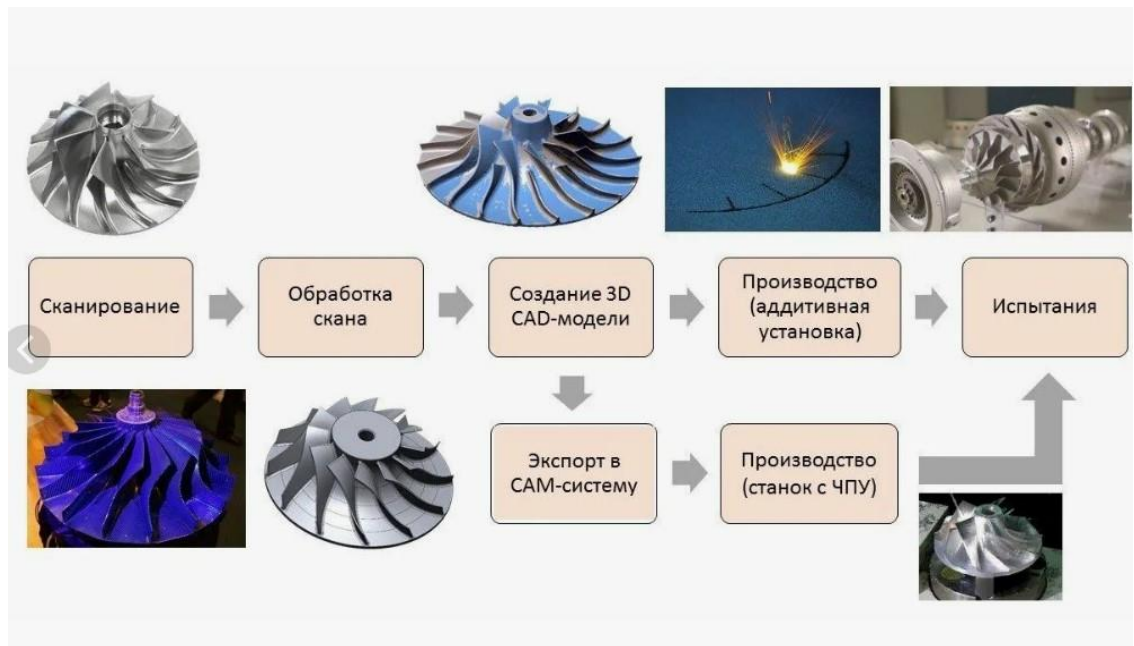
Рис. 1 - Схема стандартного рабочего процесса обратного инжиниринга с использованием 3D-сканирования
