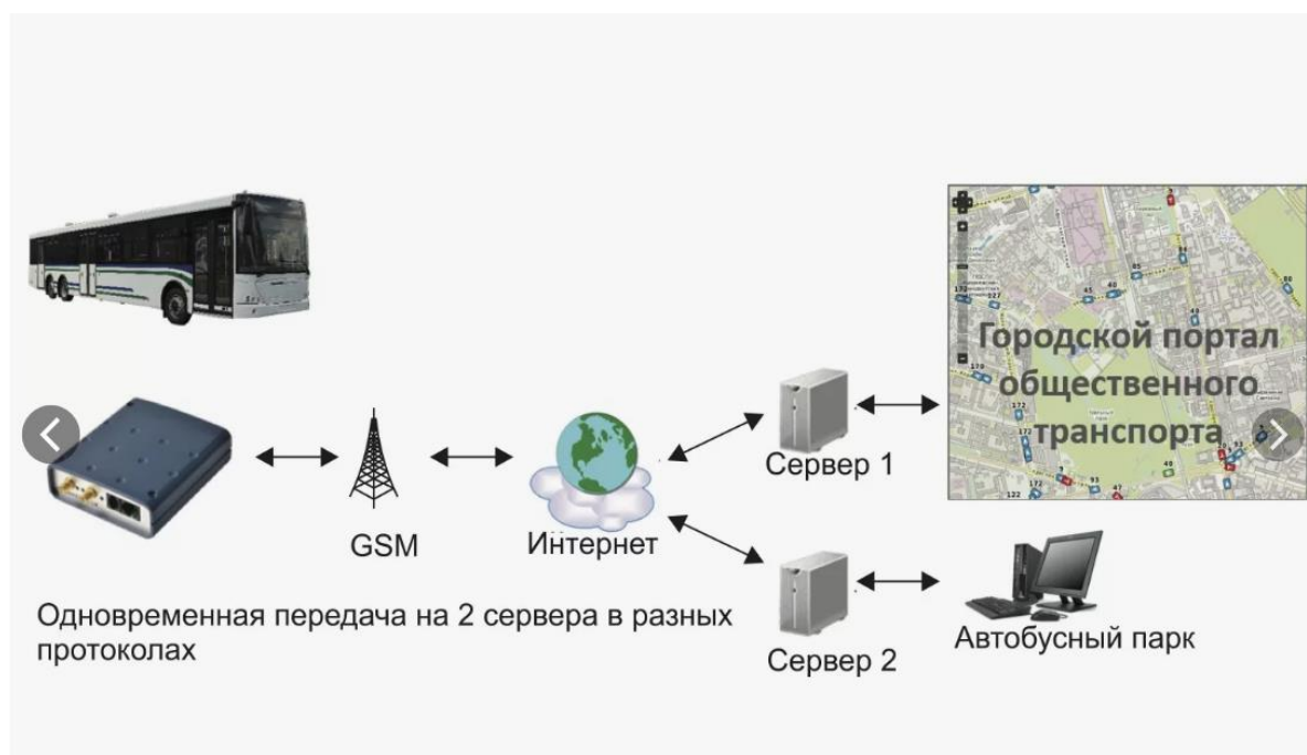
Рис.4 Общая схема оснащения общественного транспорта приемниками ГНСС
