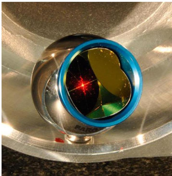
Рисунок 2 - Сферический отражатель
