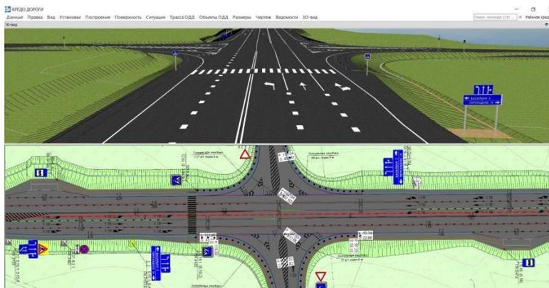
Рисунок 3 – Проектирование дороги в программе «КРЕДО-ДОРОГИ»
