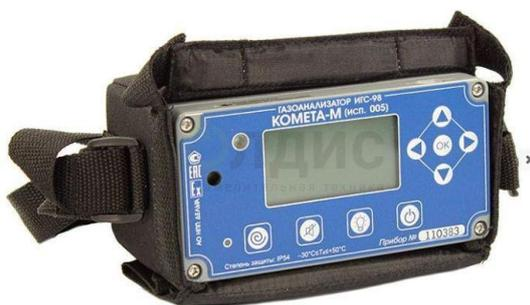
Азота диоксид 0-30 мг/м<sup>3</sup> Диоксид серы 0-300 мг/м<sup>3</sup>
